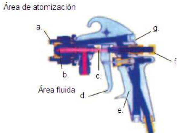
Ilustración No.5: "Partes principales de la pistola para la tecnología convencional"
