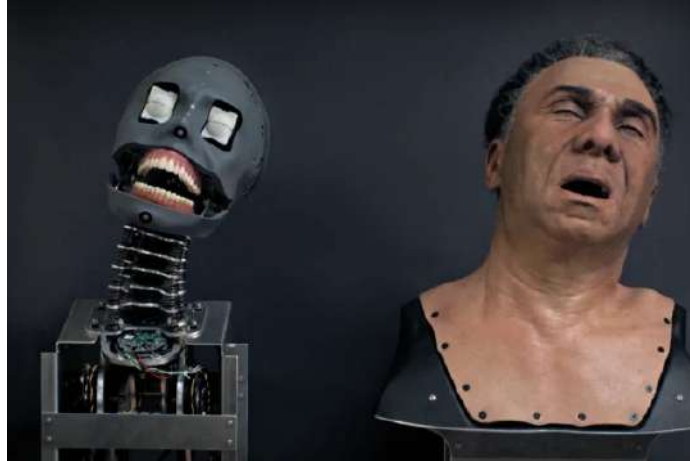
Figura 2. Animatrónico Mime Face: estructura interna y piel sintética
