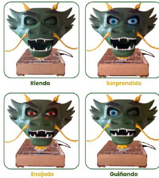
Figura 11. Ejemplos de expresiones faciales del rostro animatrónico de Jack
