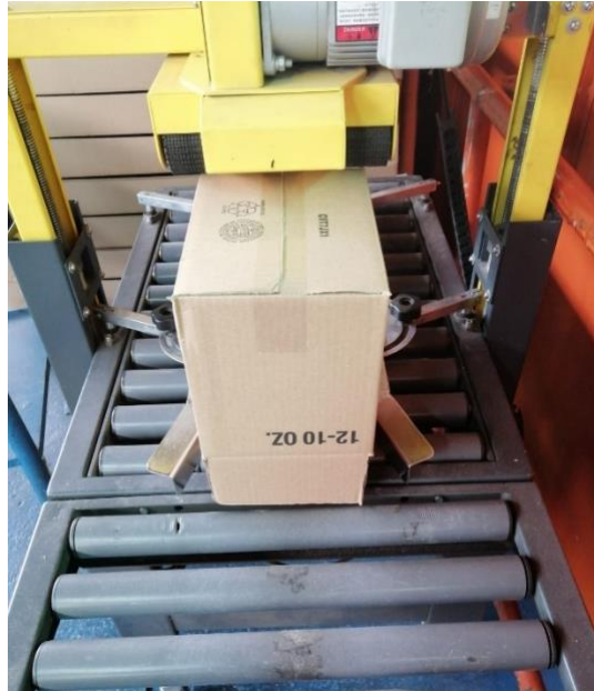
Ilustración 13 - Salida de caja encintada en encintadora de bandas superiores e inferiores #1
