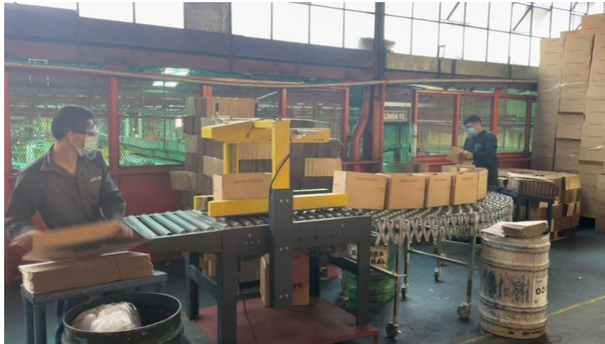
Ilustración 19 - Segunda prueba de encintadora de bandas laterales con carril extensible
