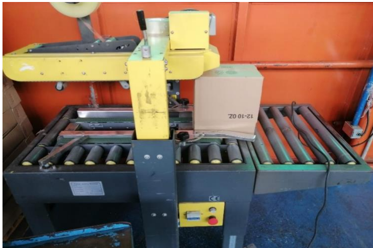
Ilustración 14 - Salida de caja encintada en encintadora de bandas superiores e inferiores #2
