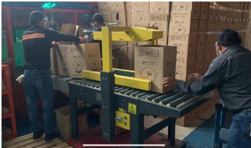
Ilustración 18 - Primera prueba en línea de encintado con encintadoras de bandas laterales #2
