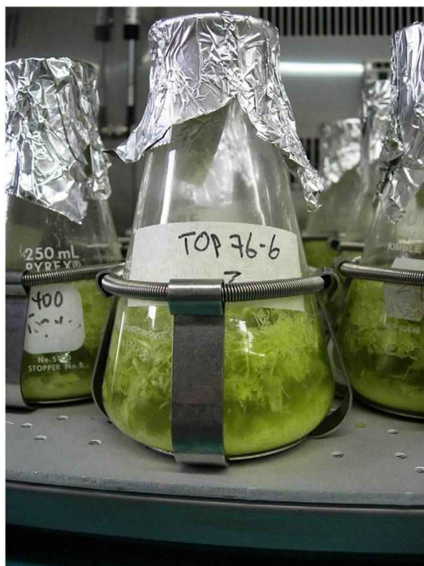
Figura 2. Extracción y fermentación simultáneas de partículas de tallo molido en frascos agitados. Figure 2. Simultaneous extraction and fermentation of ground stem particles in shake flasks.
