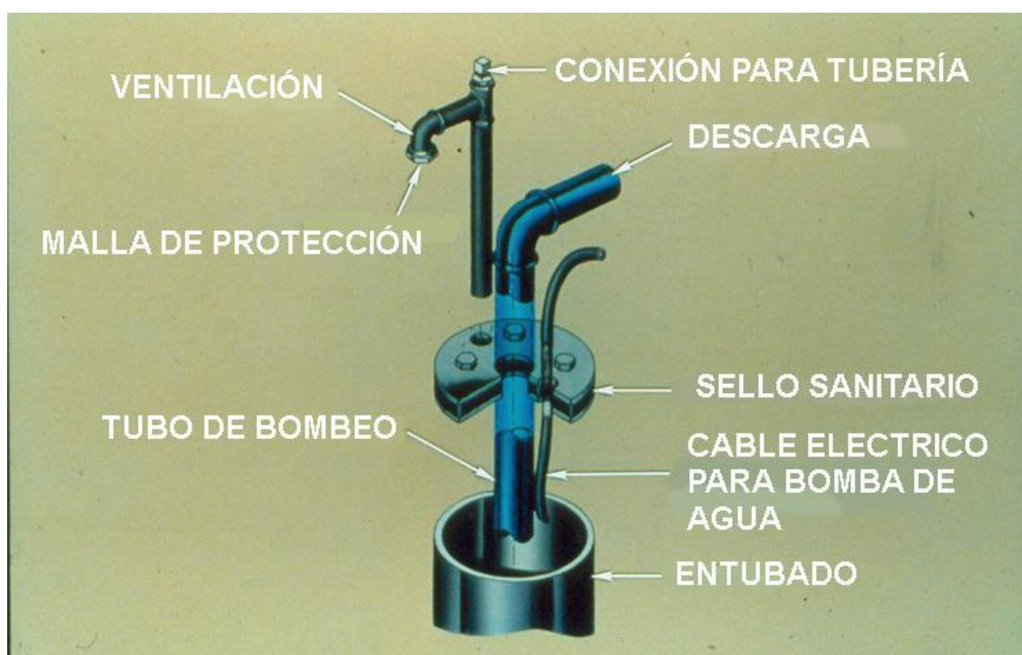
Figura 13. Sello sanitario de un pozo.
