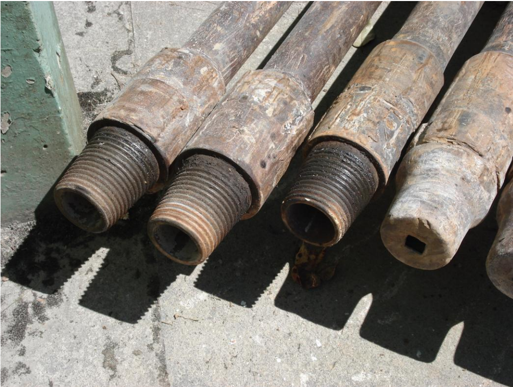
Imagen 19. Tubería de perforación.
