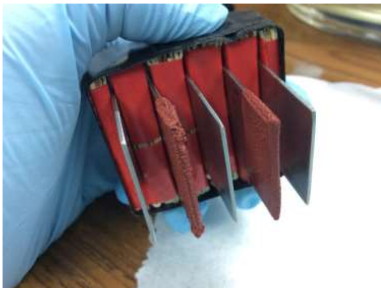
Ilustración 41: Sistema de electrodos después de 10 minutos de reacción para la oxidación-reducción de la plata.
