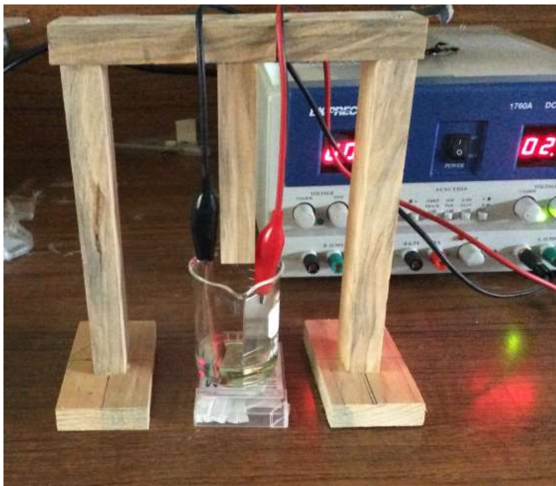
Ilustración 14: Arreglo de los electrodos para su correspondiente evaluación usando 25.0 mL de una solución de 0.1M de \text{CuSO}_4 .
