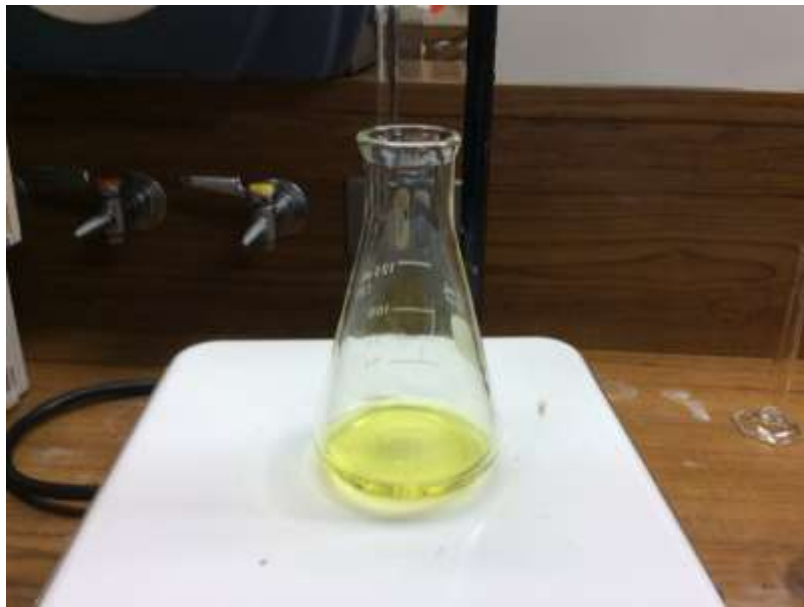
Ilustración 44: Solución patrón de KCl con 7 gotas de indicador, para la titulación de una solución electrolítica de plata.
