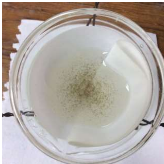
Ilustración 47: Sólidos de \text{NaHCO}_3 removidos de la solución electrolítica usando filtración.
