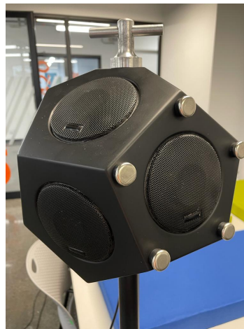
Figura 32. Bocina dodecaédrica marca Larson Davis utilizada para la generación del campo difuso para la medición de tiempo de reverberación
