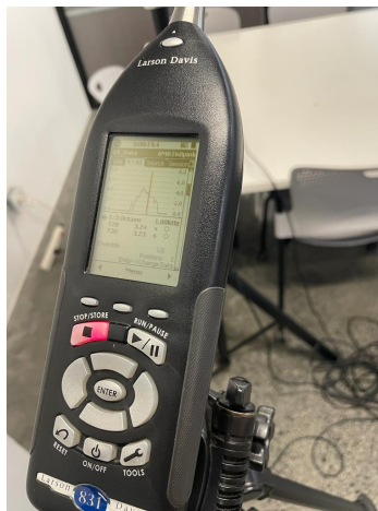
Figura 30. Sonómetro marca Larson Davies Clase 1, utilizado para las mediciones de tiempos de reverberación de frecuencias en tercios de octava
