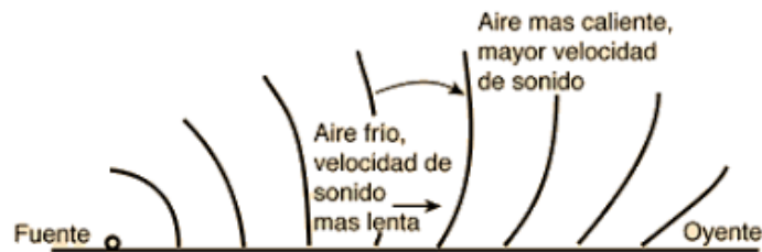
Figura 2. Ejemplificación gráfica de refracción de ondas sonoras ante distintas condiciones de medio de propagación.
