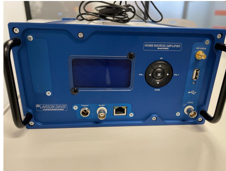
Figura 31. Amplificador marca Larson Davis utilizado para emisión de ruido rosa para mediciones de tiempo de reverberación
