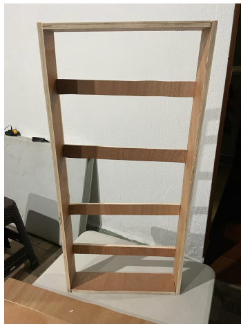
Figura 27. Bastidor de plywood para panel acústico de micelio de hongo ostra
