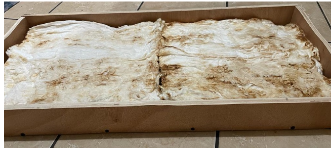
Figura 28. Bastidor de playwood con relleno de 7 cm micelio de hongo ostra
