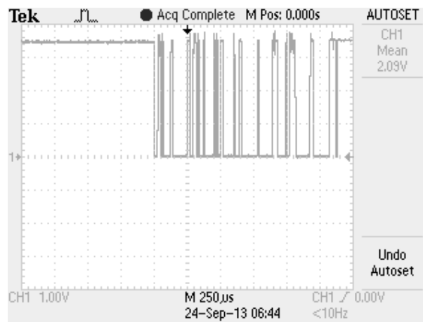
Figura 54. Señal de pin SDA (Datos Serial) de comunicación I2C de PIC18F25k20 y DS1307.
