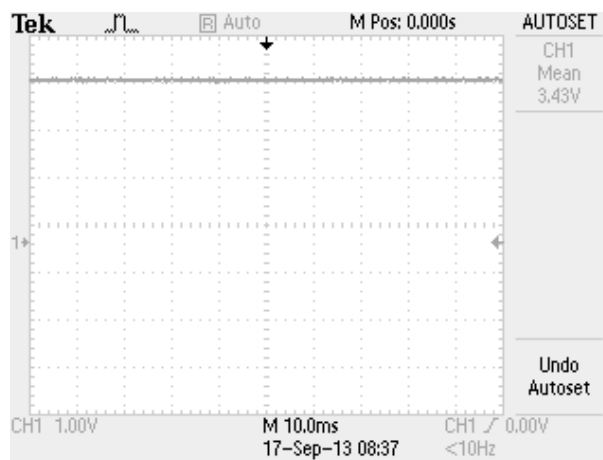
Figura 41. Señal analógica de sensor LV MaxSonar MB7389 a 5 metros.
