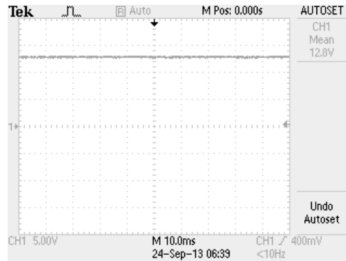
Figura 44. Voltaje de salida de transformador.
