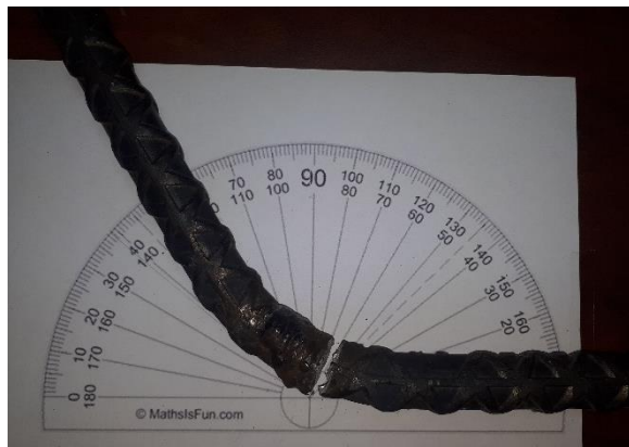
Figura 21. Medición de grados de doblez, barra A615 (1)
