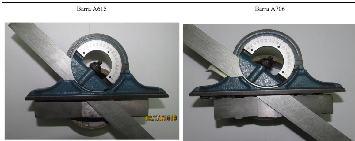
Figura 32. Medición de ángulo de bisel, ensayo macroataque
