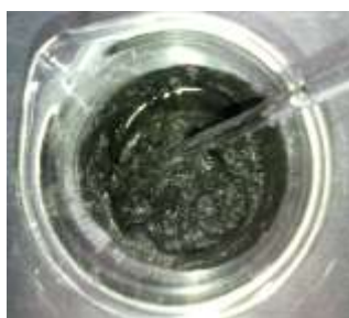
Figura 9. Mezcla de ceniza y diclorometano con un factor de multiplicación de 30 respecto al punto de saturación de solubilidad del activador en el diclorometano
