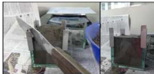
Figura 7. Eliminación de sólido excedente en extensión inferior
