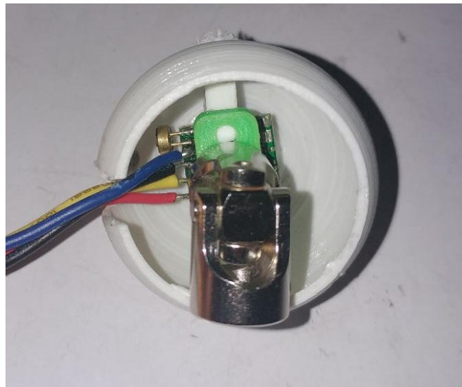
Figura 110. Cámara OOSXX integrada dentro del ojo
