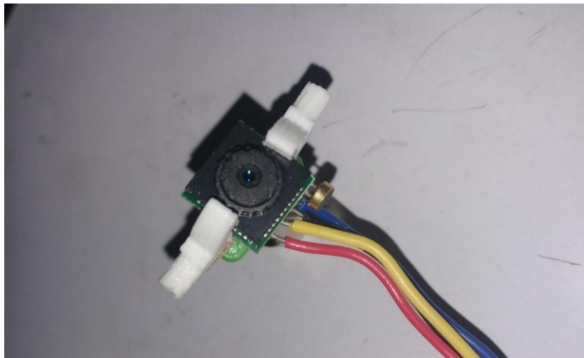
Figura 108. Cámara OOSXXX sujeta al mecanismo interno del ojo
