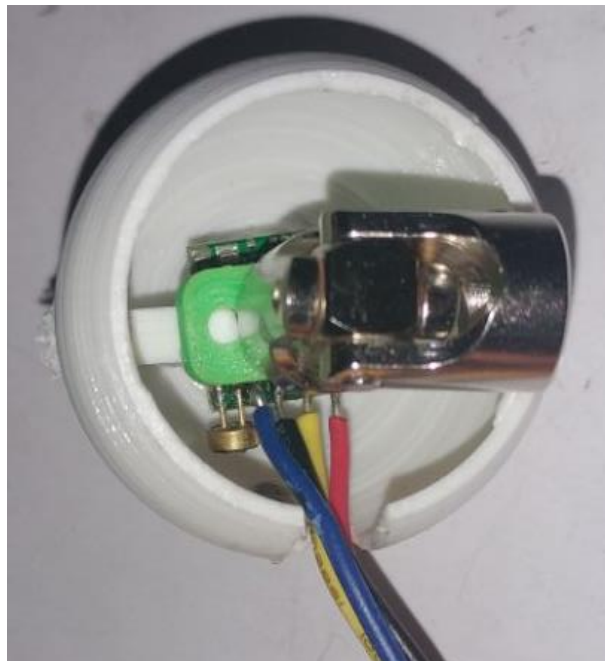
Figura 89. Ensamble de junta universal con el ojo que sostiene la cámara
