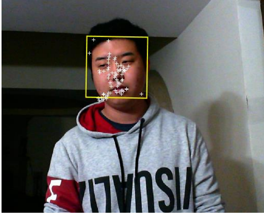
Figura 52. Prueba de detección inicial con cuadro de detección recto
