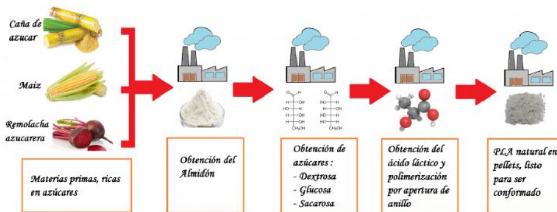
Figura 30. Proceso de obtención del PLA
