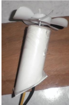
Figura 18: Motor acuático impermeabilizado.
