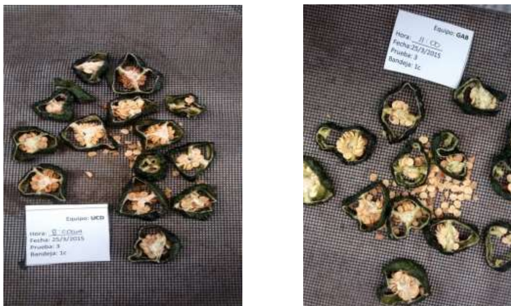
Figura No. 64: Calidad final del producto con un 17% del peso inicial UCD (izq.) y gabinete (der.)
