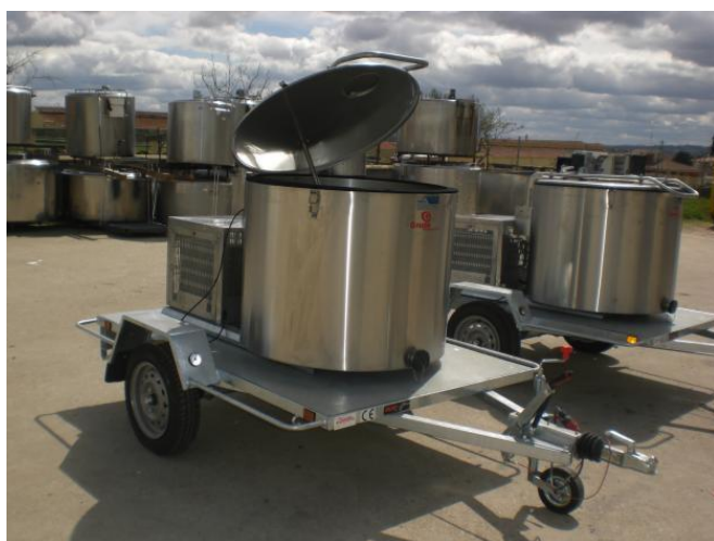
Figura No 7. Tanque de enfriamiento de leche.
