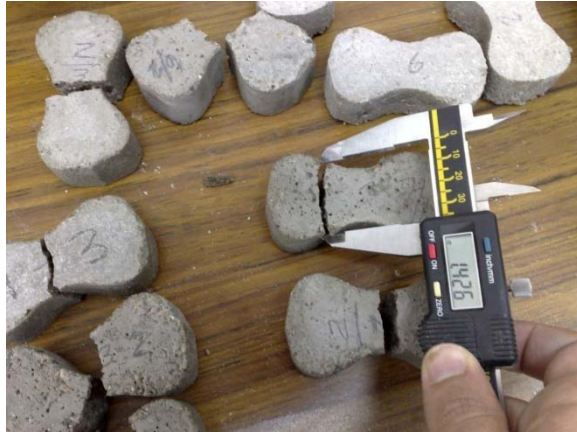
Figura 57: Medición del ancho de la falla de la briqueta fallada
