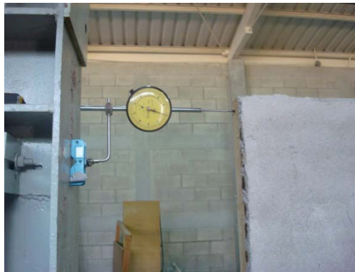
Figura 45: Manómetro utilizado para la lectura de la carga aplicada a los paneles.
