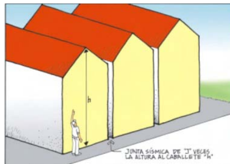
Figura 15: Calculo junta sísmica entre edificaciones (2)
