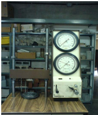
Figura 8: Equipo para ensayo a tensión (ASTM D2938, D3148).
