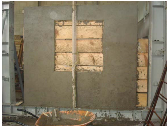
Figura 37: Panel totalmente repellado
