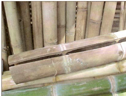
Figura 25: Bambú guadua del que se fabrica la esterilla (13)
