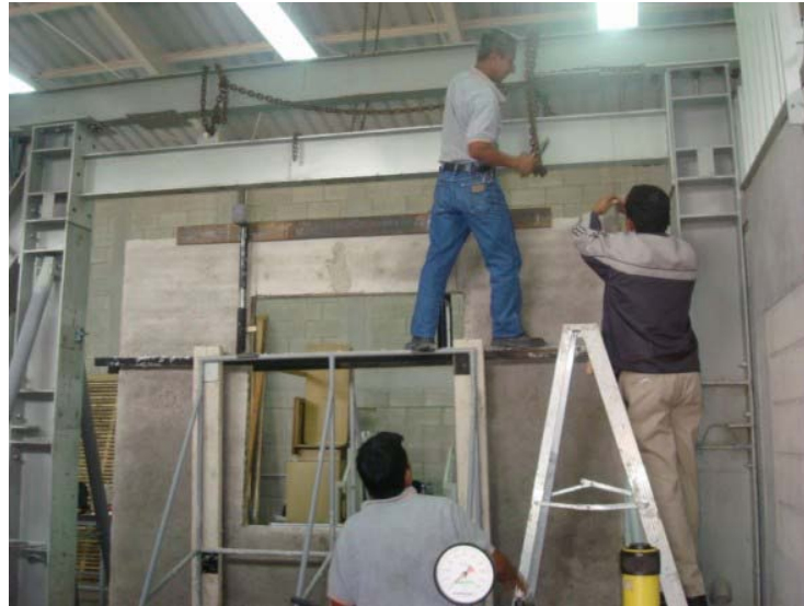
Figura 42: Soporte lateral para evitar la traslación de los paneles.
