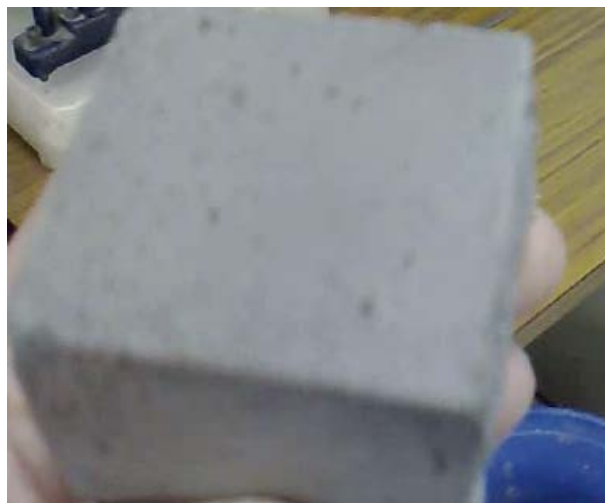
Figura 51: Testigo cúbico hecho conforme especificaciones, sin vacíos ni poroso
