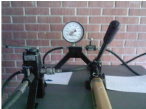
Figura 45: Manómetro utilizado para la lectura de la carga aplicada a los paneles.
