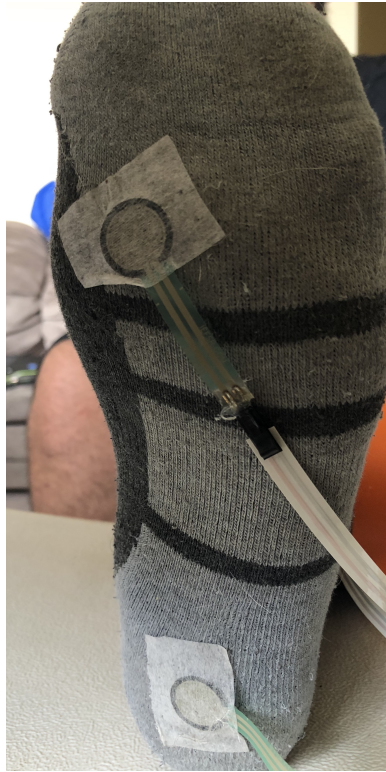
Figura 42: Posición de sensores en pié de usuario
