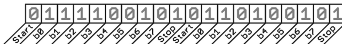
Figura 5. Modelo de transmisión de datos con la interfaz UART.
