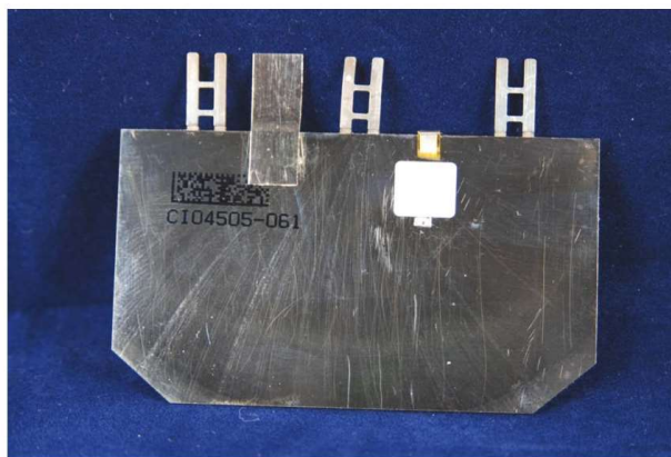
Figura 42. Celda con el contacto de lámina adherido.
