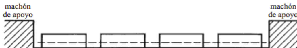
Figura No. 30. Cama de concreto pre esforzado y viga postensada.
