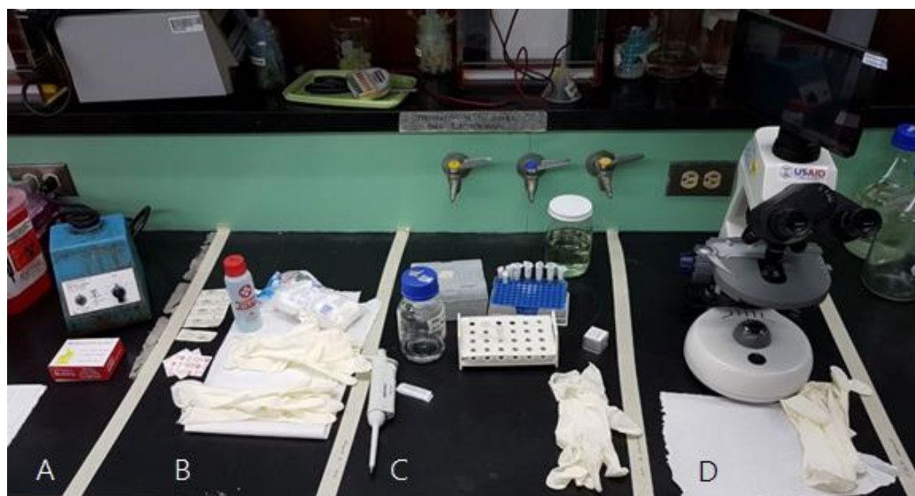
FIGURA 17. Estaciones de trabajo para ensayo hemolítico en donde A- estación de descarte y vórtex, B- estación de toma de muestra, C - estación de inoculación de sustancias, D - estación de observación.
