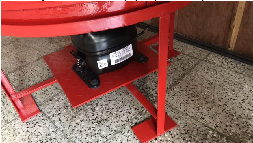
Figura 21. Base finalizada con ejemplo de posición del compresor.
