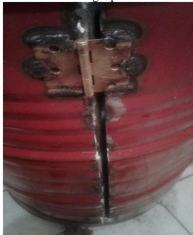
Figura 18. Soldadura de bisagra para unir los dos elementos.
