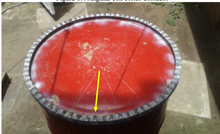
Figura 19. Angular con cortes doblado.
