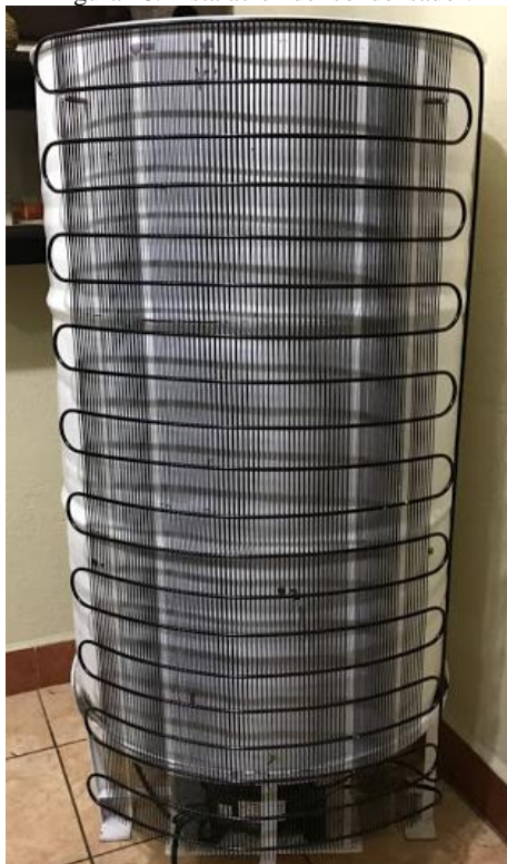
Figura 28. Instalación del condensador.
