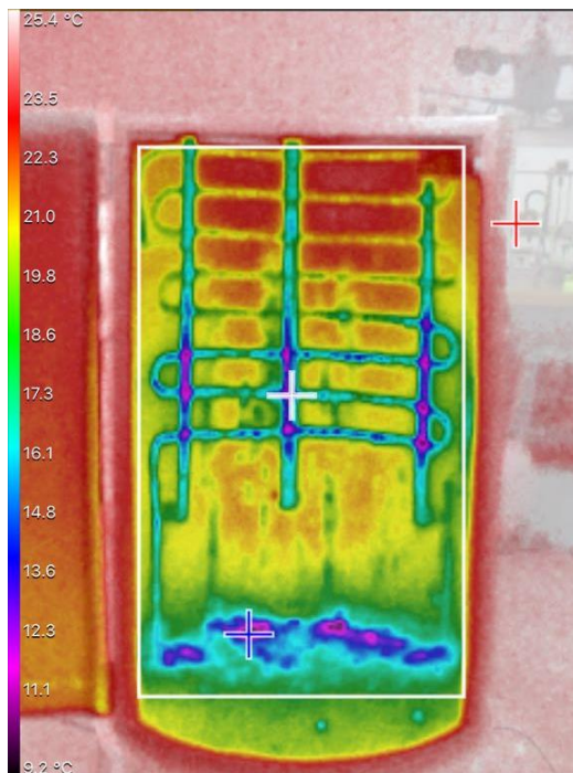
Análisis termográfico en el interior mientras el sistema de refrigeración se encuentra apagado luego de 3 minutos.
