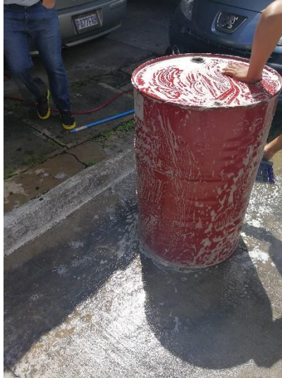
Figura 12. Tonel Norma UNE-EN 12711:2001 utilizado
