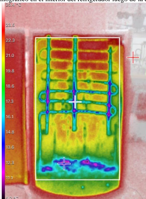
Figura 33. Análisis termográfico en el interior del refrigerador luego de la desconexión del sistema.
