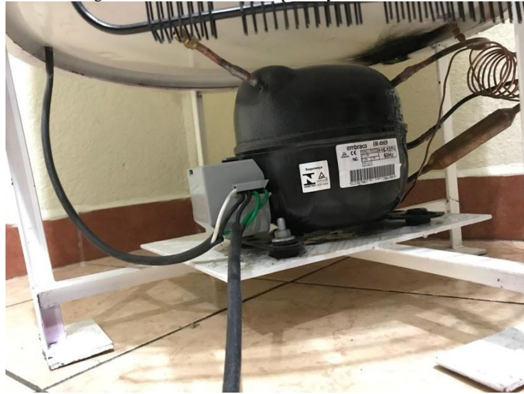
Figura 29. Instalación del compresor y sistema eléctrico.
