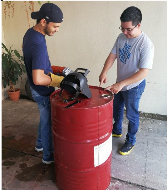
Figura 14. Proceso de corte del tonel de acuerdo con medidas
