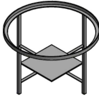
Figura 10. Base del refrigerador.
