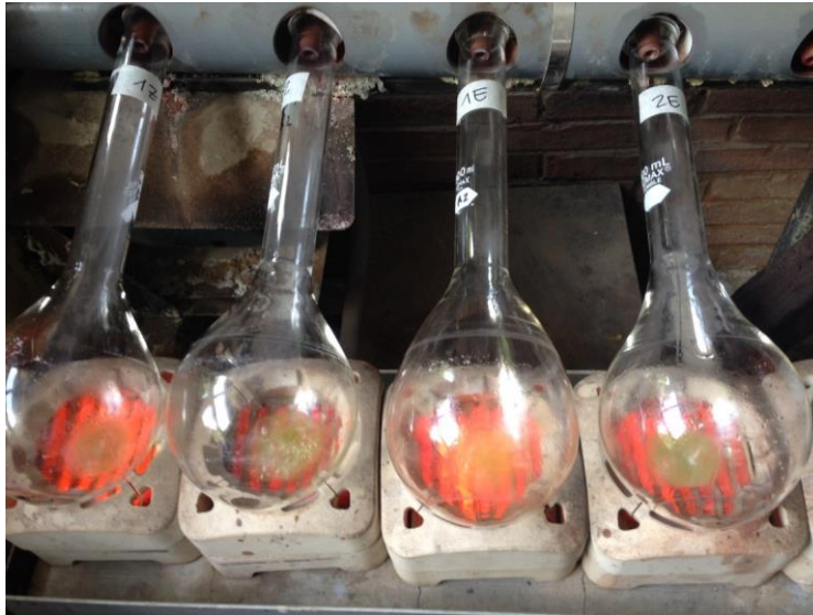
Ilustración 26: Fotografía de elaboración de análisis grasas y proteínas a través de método Kjeldahl y Soxhlet
