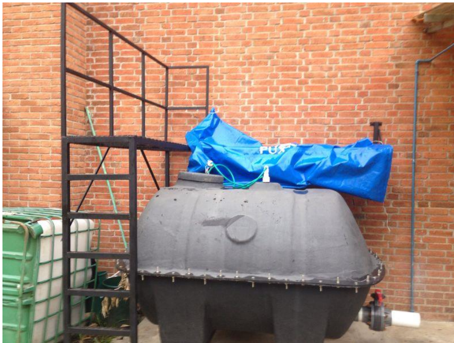
Ilustración 25: "Biodigestor piloto semana 2 con carga de residuos sólidos provenientes de Zoológico "La Aurora"
