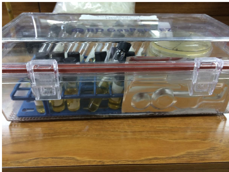
Figura 22. Caja de anaerobiosis utilizada en el análisis microbiológica. Están cerrada herméticamente, los tubos con las muestras en el interior, el GasPak (paquete de aluminio) y el indicador que no se observa en esta imagen. La caja se colocaba dentro de la incubadora a 42°C durante 48 horas.
