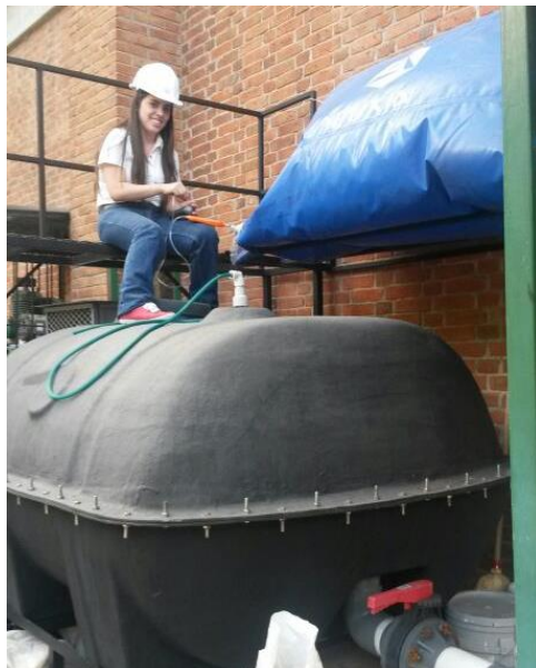
Ilustración 31: Medición de composición de biogás producido durante biodigestión anaeróbica
