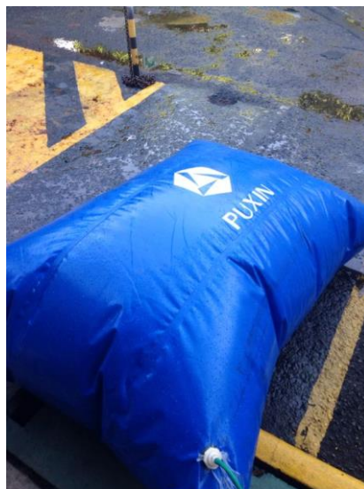
Ilustración 27: "Bolsa de biogás después de 3 semanas de biodigestión anaerobia de los desechos sólidos orgánicos generados en Zoológico "La Aurora"
