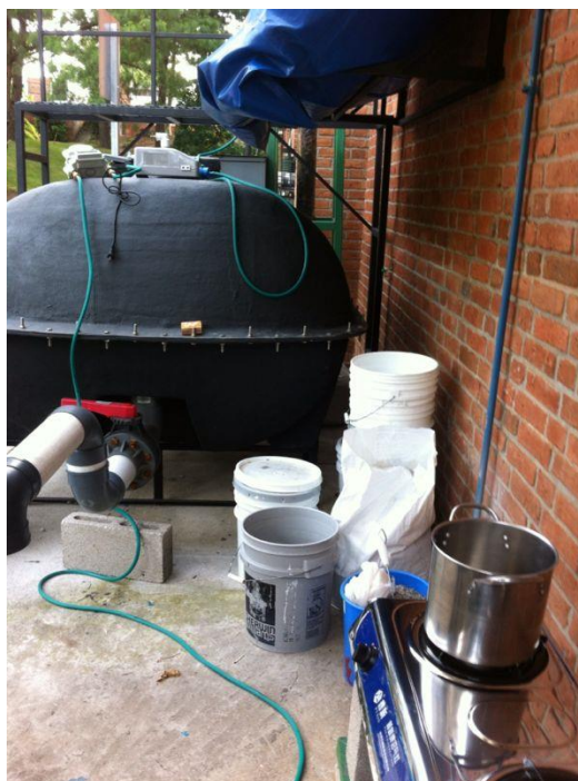
Ilustración 28: Prueba piloto estufa funcionando con biogás
