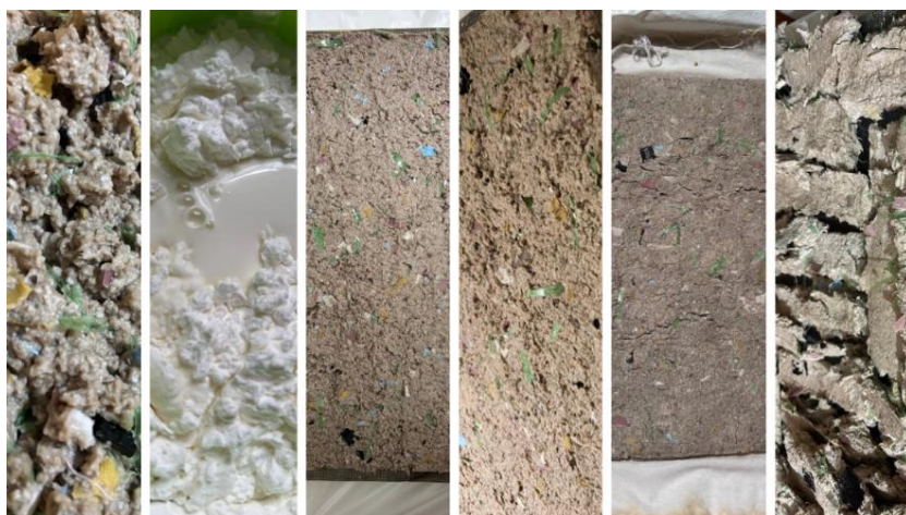
Figura 24. Proceso de fabricación de panel
