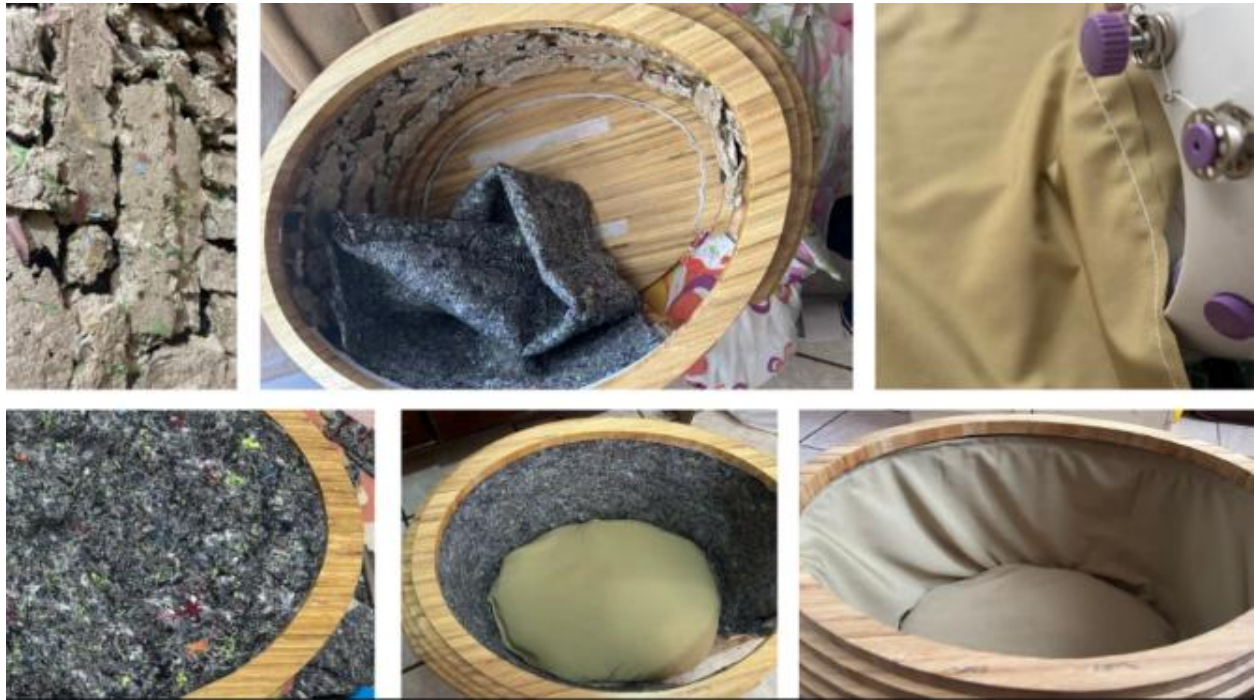
Figura 28. Instalación de panel de sonido y capas externas
