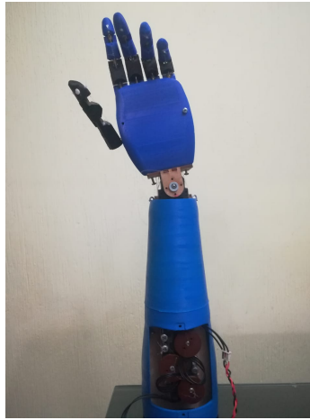
Figura 101: Ensamble completo de mano y antebrazo.
