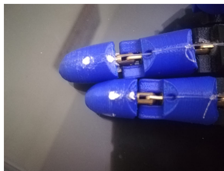
Figura 93: Relleno de porcelana en las falanges distales.
