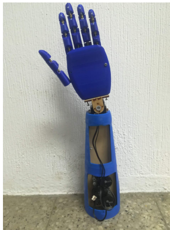
Figura 102: Ensamble de prototipo funcional de mano y antebrazo.
