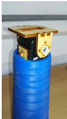
Figura 97: Ensamble muñeca y antebrazo.
