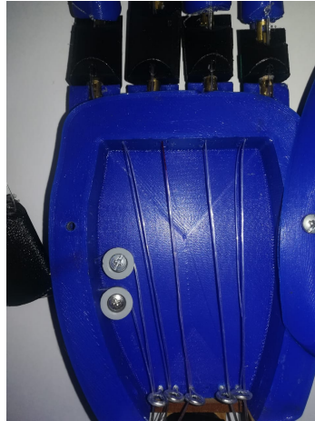
Figura 92: Cojinetes y tendones montados en la palma.
