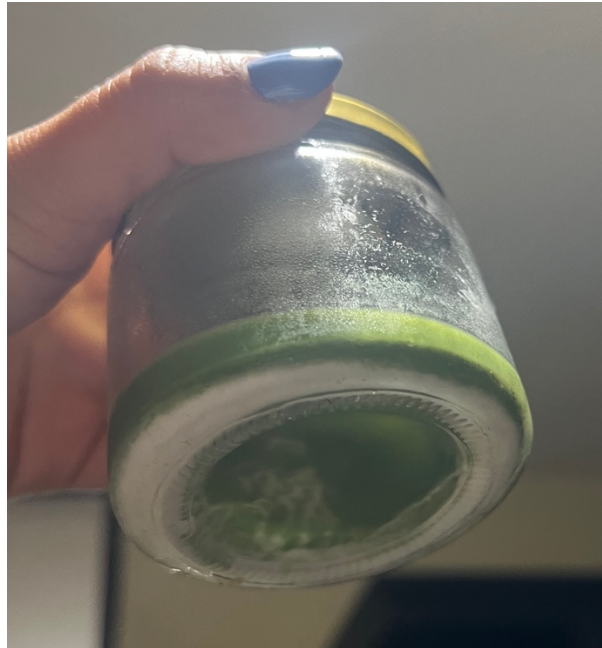
Figura 21. Almidón sedimentado en el fondo del frasco de vidrio almacenado.
