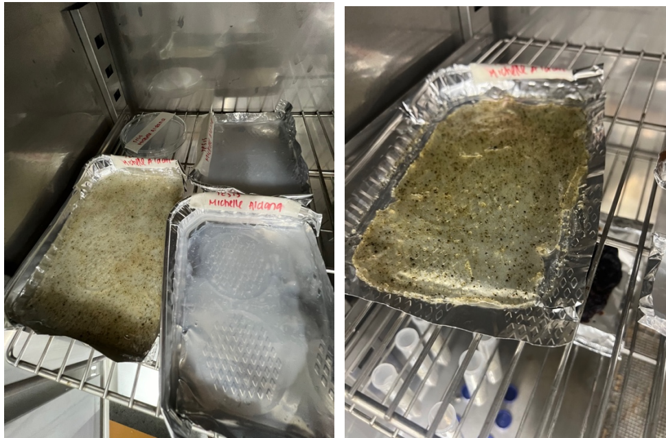
Figura 37. Secado de biopolímero producido empleando formulación 2 (el de la derecha fue despegado del molde para que el calor llegue a todas partes)
