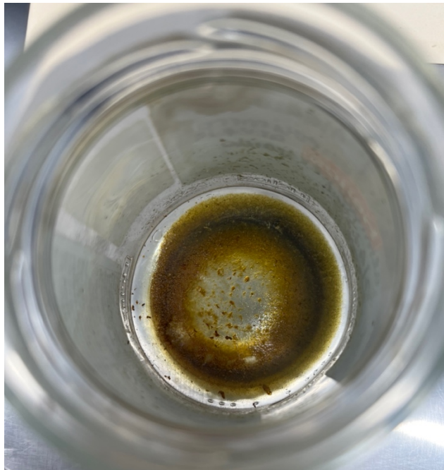
Figura 22. Secado parcial de polisacárido extraído en método 1 (Presentó una coloración y olor extraño- Caramelizado)
