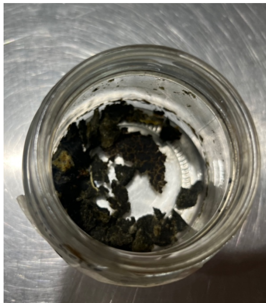
Figura 24. Secado total de extracto de polisacárido (textura, olor y color extraño: ceras adicionadas en filtro de manta)
