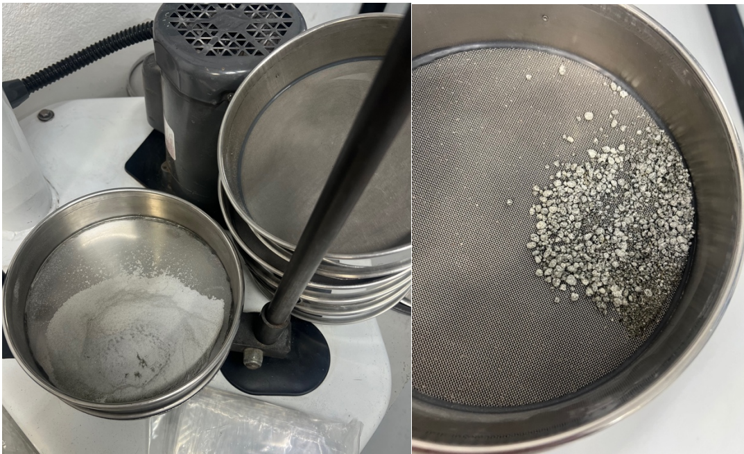
Figura 42. Incorporación de proceso de tamizaje para mejorar textura de biopolímero producido
