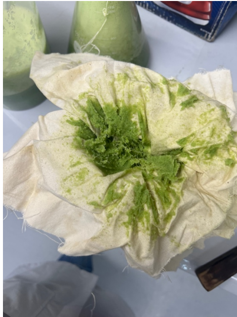
Figura 23. Alternativa de filtrado de fibra (papel filtro no permitio paso, se saturo en poco tiempo)
