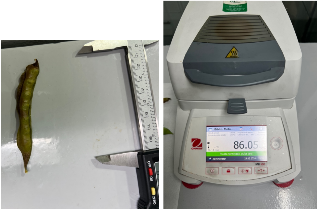
Figura 13. Determinación de porcentaje de humedad B.H.(m/m) de vaina de arveja
