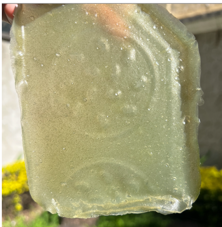
Figura 6. Biopolímero resultante empleando el método de modificaciones química seleccionada a partir de extracto de polisacárido de Arveja China ( Pisum sativum ).
