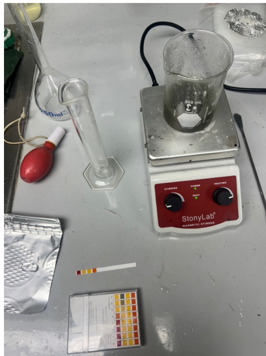
Figura 36. Polimerización (extracto de polisacárido adición de glicerina, ácido acético y agua)
