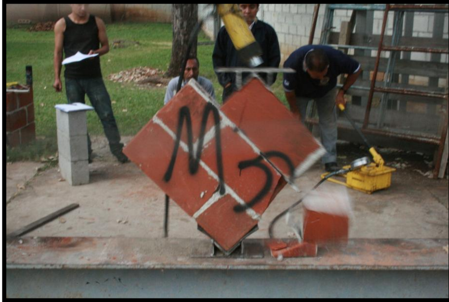
Ilustración 88. Prisma ensayado M3 (Falla combinada).
