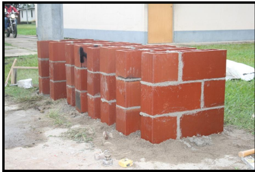
Ilustración 81. Prismas a someterse a ensayo a compresión diagonal.
