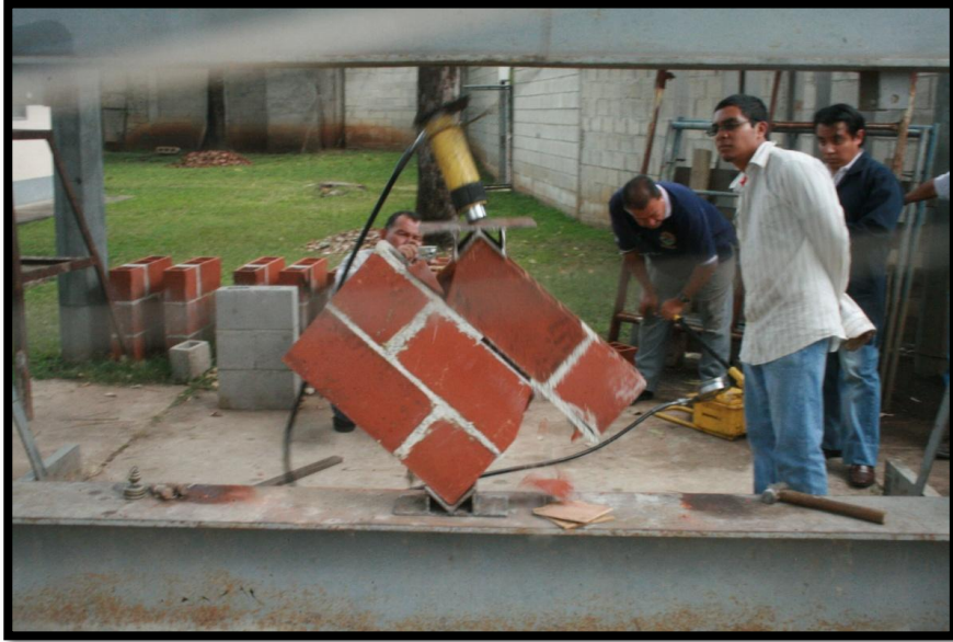
Ilustración 82. Prisma ensayado S1 (falla por adherencia).
