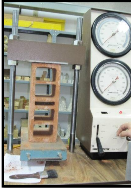
Ilustración 78. Compresión de unidad de ladrillo.
