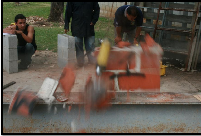
Ilustración 86. Prisma ensayado M1 (Falla por adherencia).
