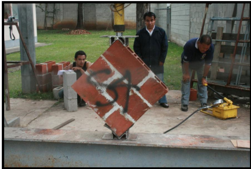
Ilustración 85. Prisma ensayado S4 (Falla combinada).
