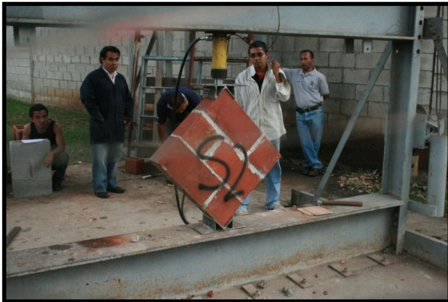
Ilustración 83. Prisma ensayado S2 (Falla combinada).
