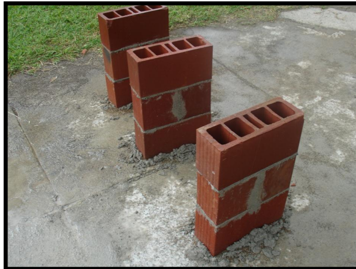
Ilustración 79. Prismas de ladrillo ensayados a compresión.
