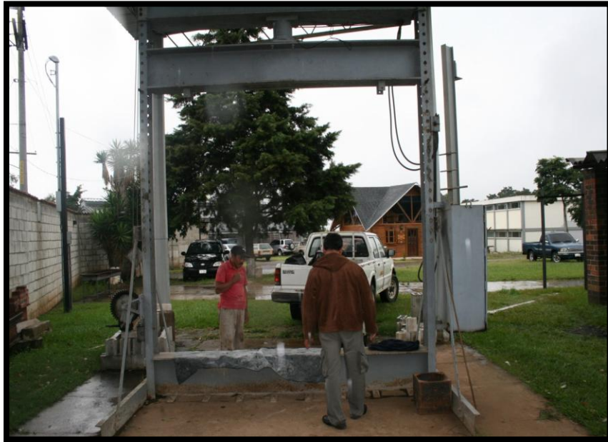
Ilustración 52. Marco de pruebas a compresión.
