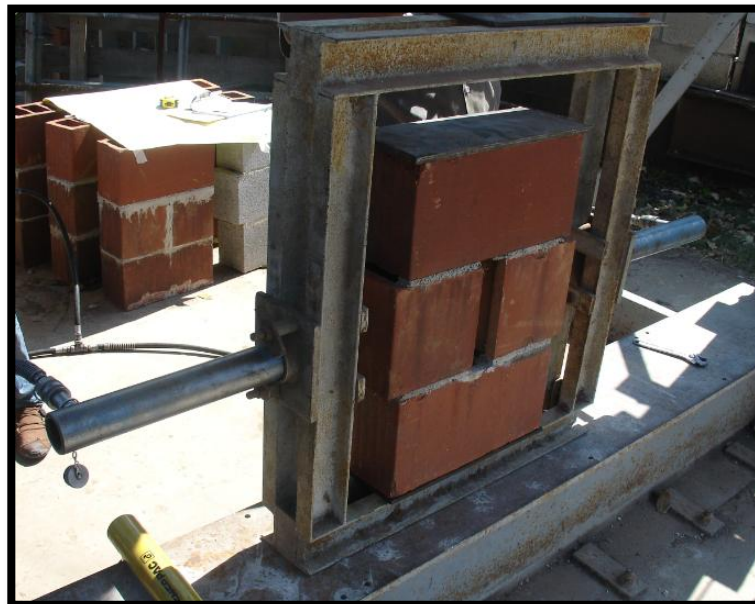
Ilustración 77. Colocación correcta del sistema completo para el ensayo de adherencia.
