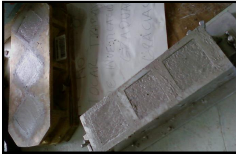
Ilustración 76. Muestra para observar antes de desencofrar las muestras de cubos de mortero.
