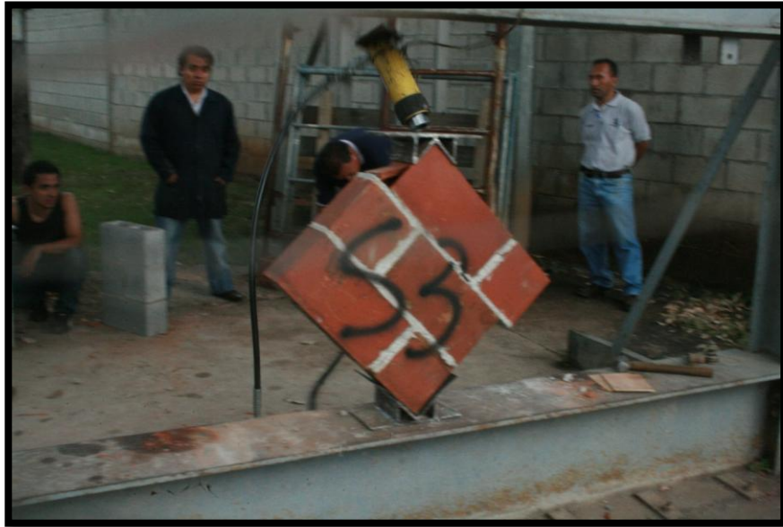
Ilustración 84. Prisma ensayado S3 (Falla por adherencia).
