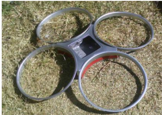
FIGURA NO. 90. ESTRUCTURA PRINCIPAL DEL CUADCÓPTERO EN FIBRA DE VIDRIO
