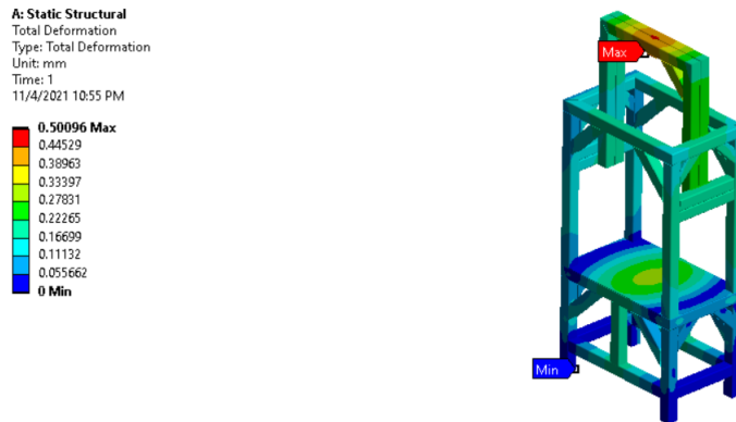
Figura 45: Deformación máxima 0.5 mm
