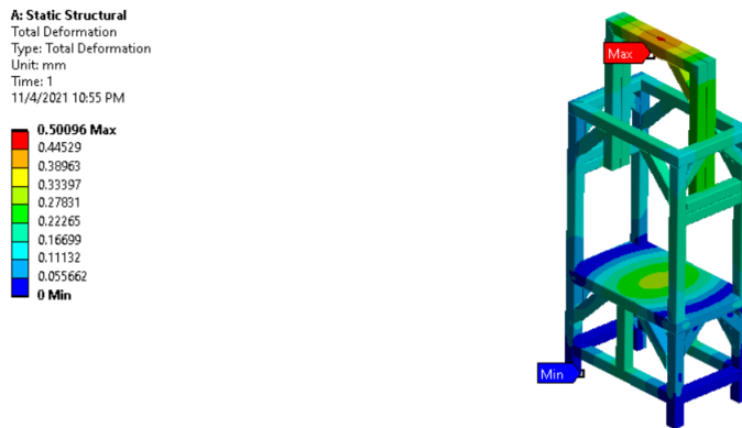
Figura 29: Deformación máxima 0.5 mm
