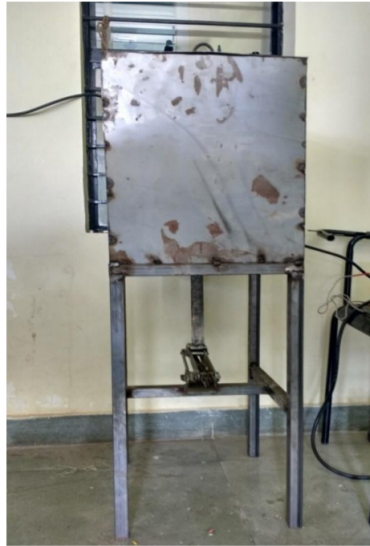
Figura 3: Estructura de una compactadora de plástico
