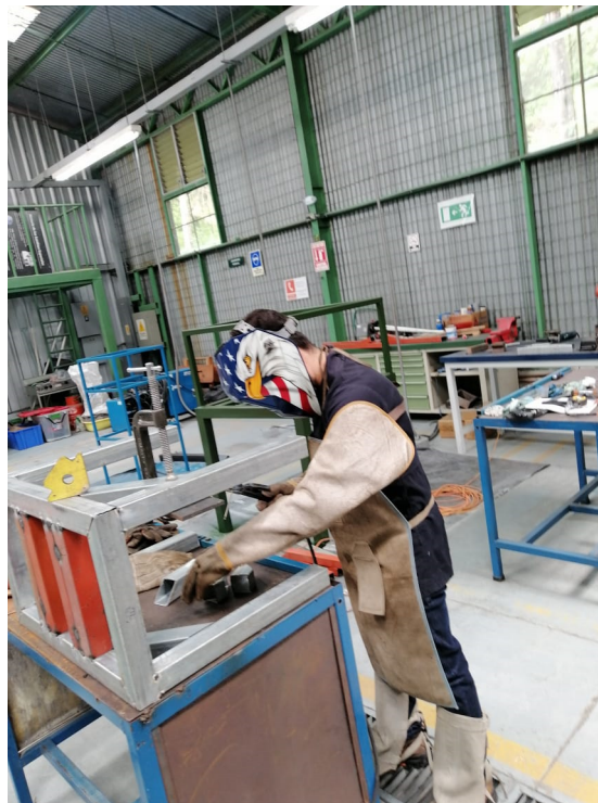
Figura 34: Soldadura de estructura
