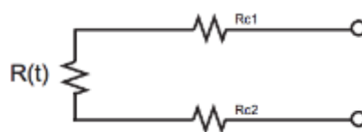
Figura 11. Conexión RTDs 2 hilos
