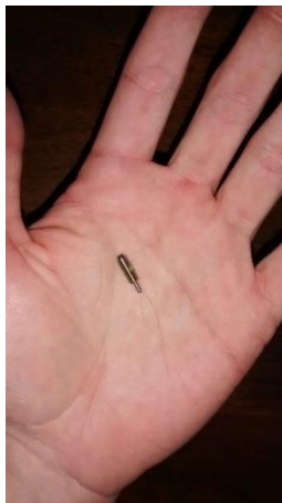
Figura 23. Comparación del tamaño de un resorte de separación con la palma de la mano.
