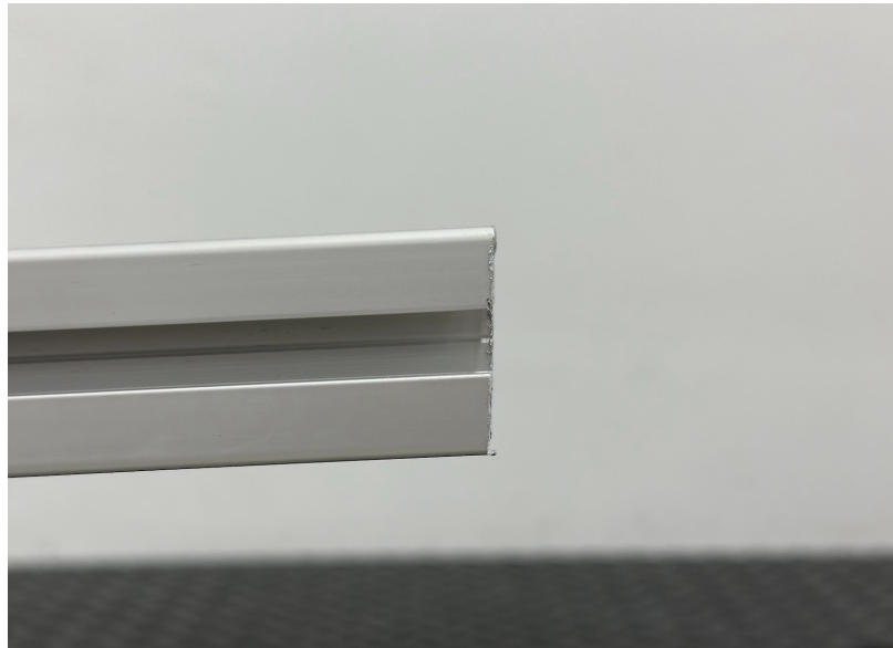
Figura 18: Perfil sin rectificar
