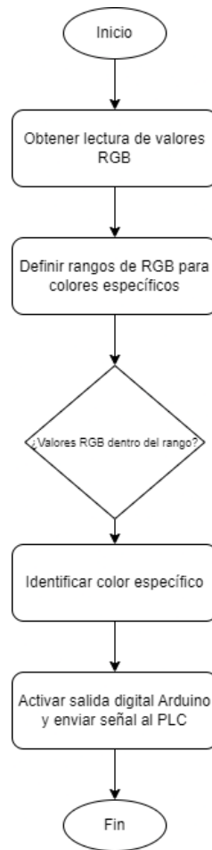
Figura 74: Diagrama de flujo programación Arduino
