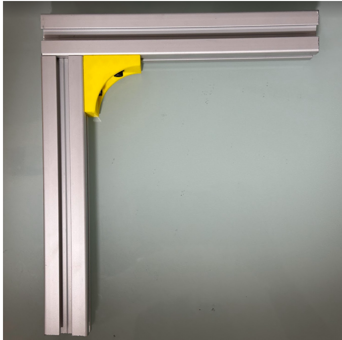
Figura 29: Prueba de unión de perfiles
