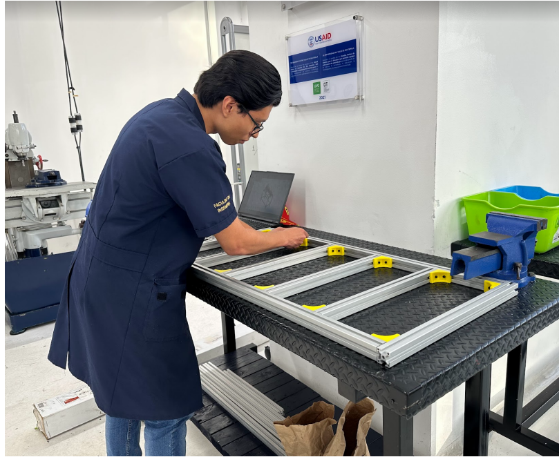
Figura 44: Ensamblando perfiles de la mesa
