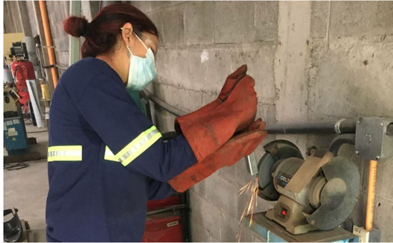
Figura 56: Lijado de perfiles cuadrados cortados.
