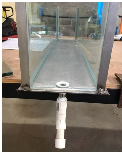
Figura 65: Accesorios de tubería de \frac{3}{4} in implementados.
