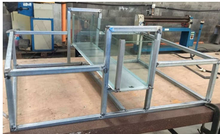
Figura 57: Uniones iniciales de soldadura.
