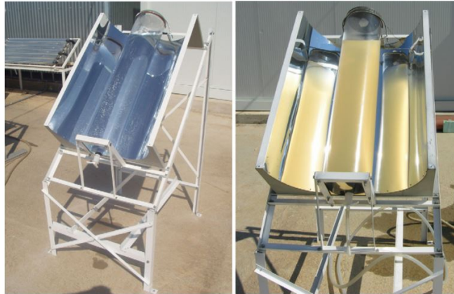
Figura 4: Reactor discontinuo mejorado SODIS de 25 L que contiene agua de 0 y 100 NTU.
