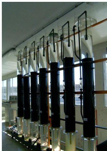
Figura 4. Filtros piloto en columnas con distintos tipos de carbón activado
