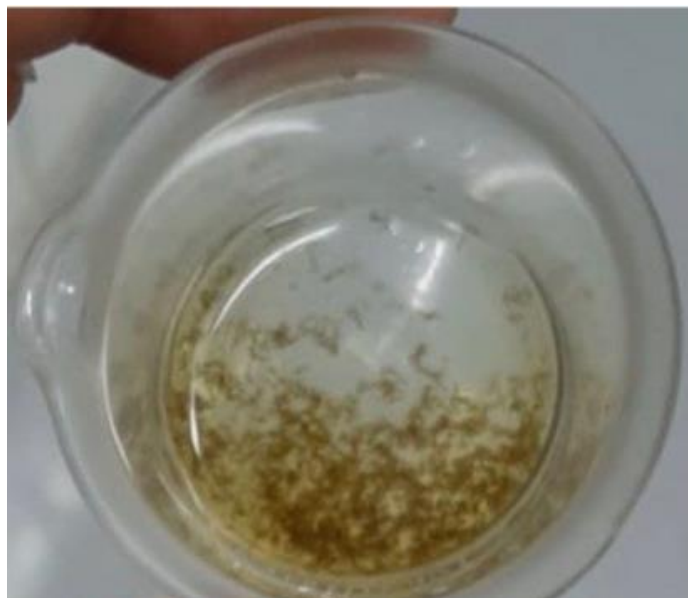
Figura 46. Resultado de la prueba cualitativa de cloruro férrico
