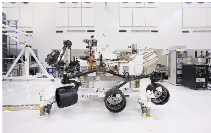
Figura 1: Suspensión Rocker-Bogie del Curiosity Rover
