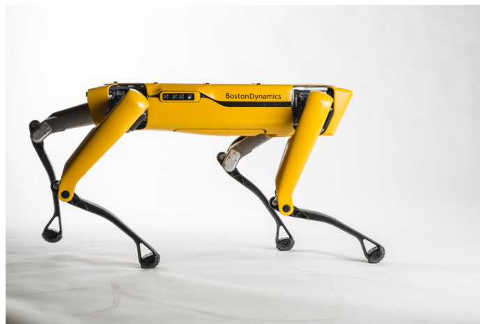
Figura 9: Spot Mini de Boston Dynamics, que adopta el concepto de máquinas que caminan. [16]
