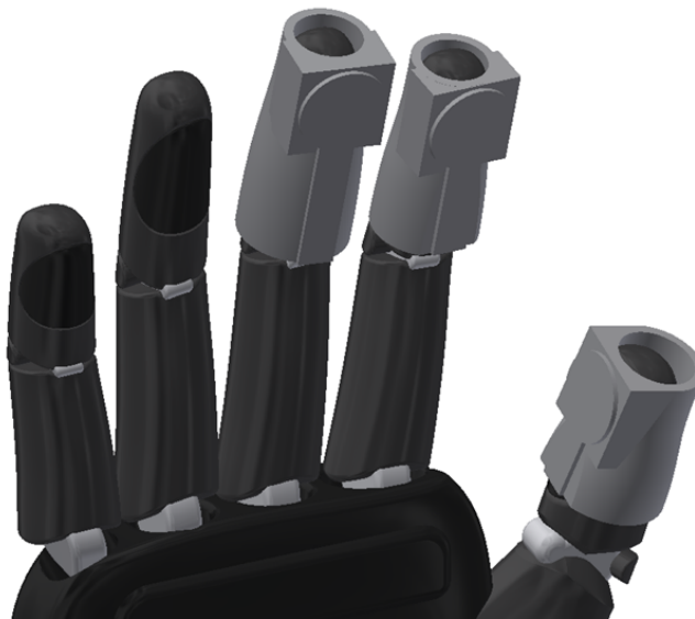
Figura 35. Encajes adaptados a diseño de prótesis transradial mioeléctrica obtenido de GrabCad [20]
