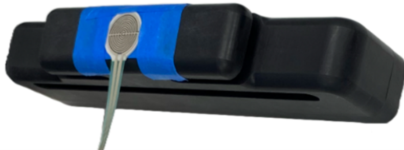
Figura 8. Sistema de obtención de datos con FSR y dinamómetro en el que se presionó el sensor con el dedo índice en dirección hacia el dinamómetro
