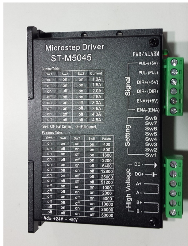
Figura 6.23: Controlador de motor paso a paso utilizado para recibir señales y realizar movimiento de los motores con modo de operación de micro-pasos.
