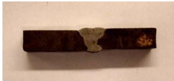
Figura 4.3: Piezas unidas por medio de soldadura heterogénea.[24]
