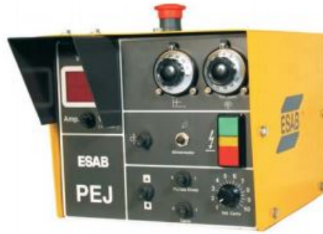
Figura 6.27: Fuente utilizada en pruebas a 27V constantes.
