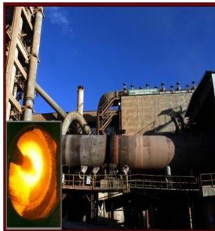
Imagen 72: Horno de preparación de clinker
