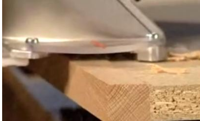
Imagen 93: Cepillado de madera para eliminar desperfectos.
