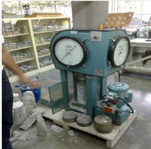
Imagen 150: Maquinaria para prueba de compresión.
