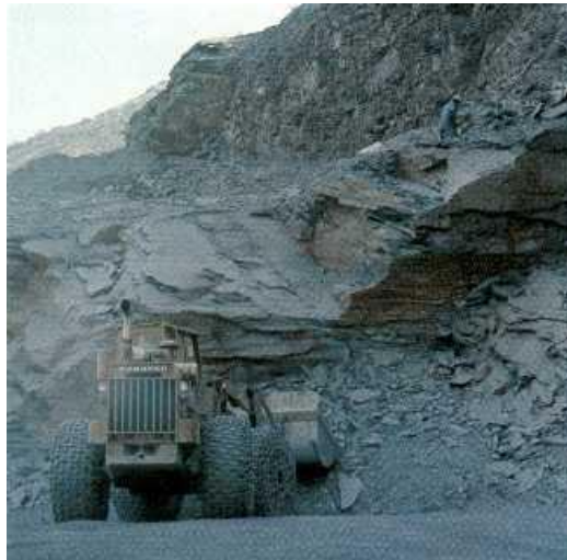
Imagen 61: Extracción de piedra caliza por medio de tractores
