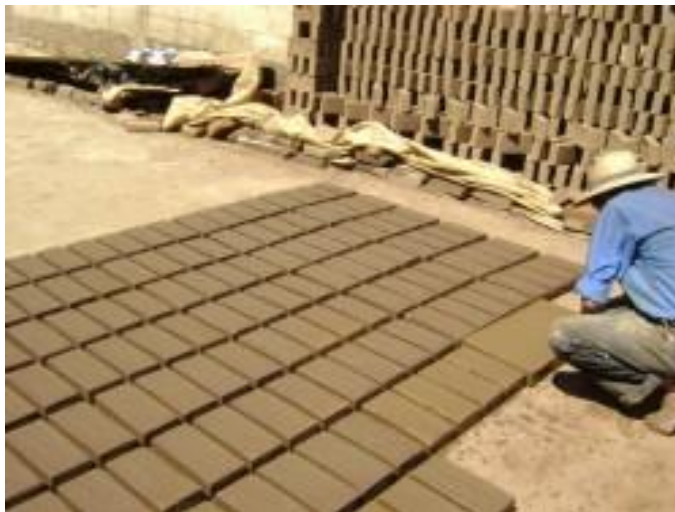
Imagen 55: Proceso de secado de ladrillo en un patio en Chimaltenango Guatemala
