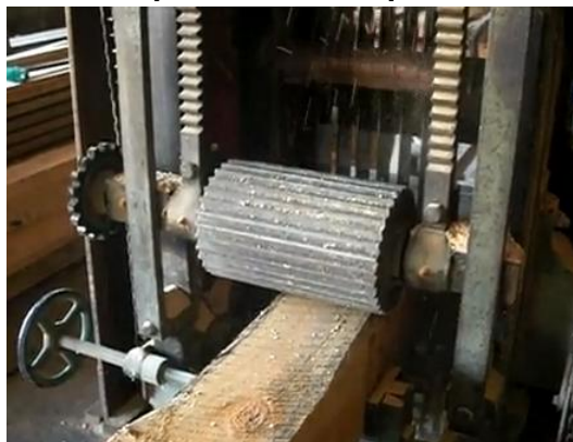
Imagen 92: Sierra múltiple alternativa que corta a medida la madera.
