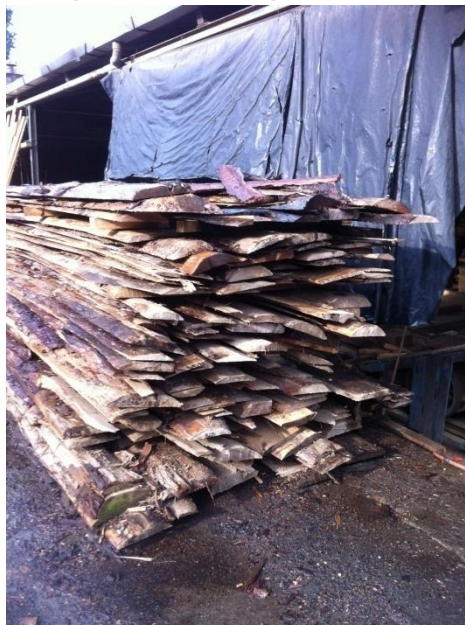
Imagen 139: Lepa de madera almacenada a la intemperie causa de generación de partículas de polvo
