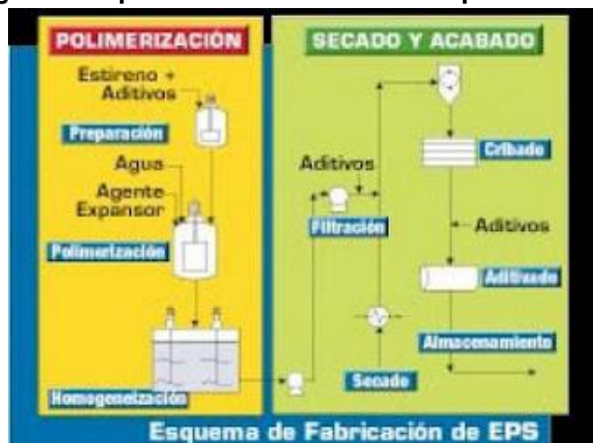
Imagen 109: Diagrama de proceso de elaboración de poliestireno expandible.
