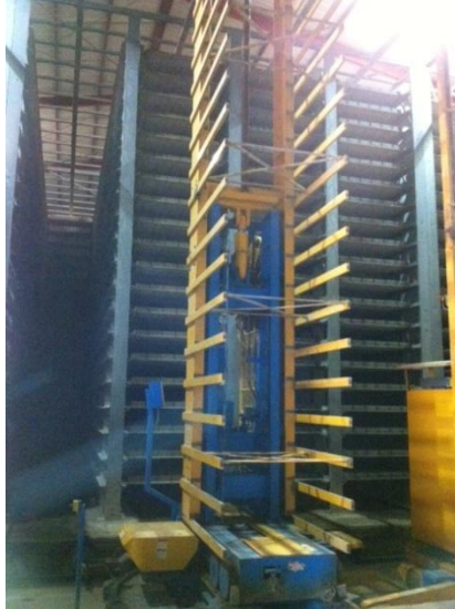
Imagen 39: Proceso de secado en cámaras donde se controla la temperatura para el nivel de saturación de agua en el block
