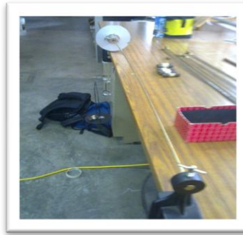
Imagen 151: Mecanismo para prueba de Torsión.
