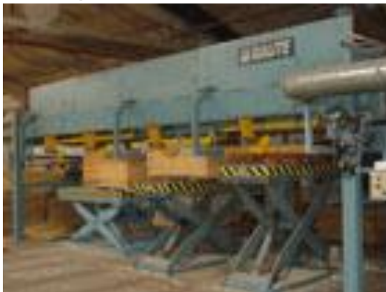
Imagen 97: Máquina de cortado de láminas de madera.
