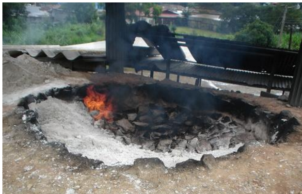
Imagen 104: Calcinación de piedra caliza donde libera dióxido de carbono.
