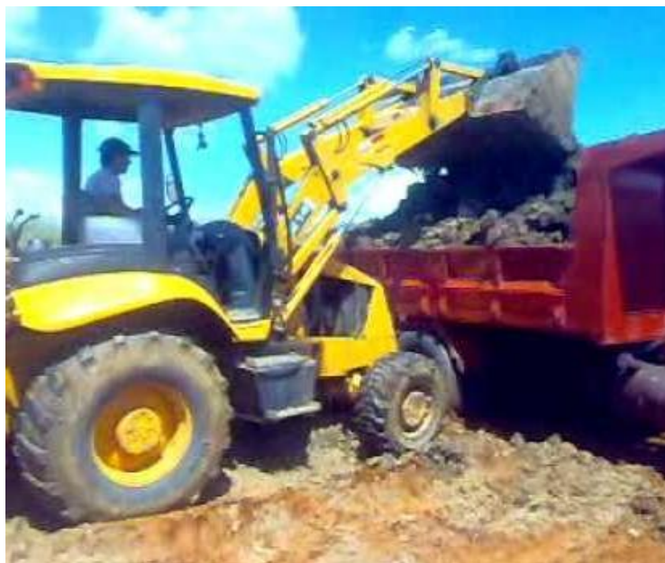
Imagen 44: Extracción de barro de forma industrializada utilizando retroexcavadoras y camiones de volteo
