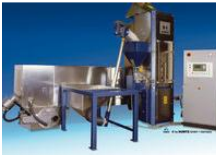
Imagen 110: Máquina preexpansora para elaboración de poliestireno expandible
