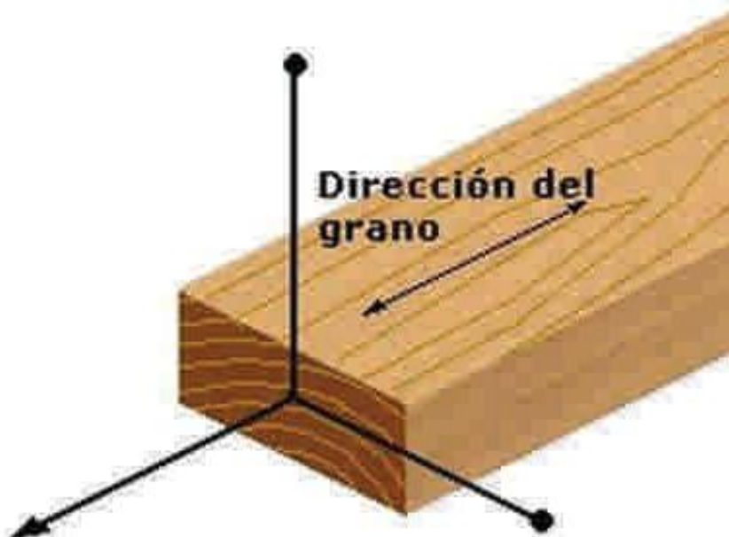
Imagen 11: Ilustración del eje axial en la madera
