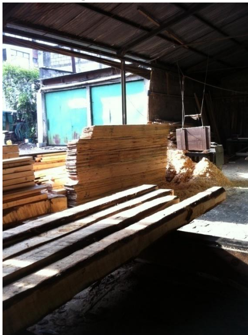
Imagen 91: Trozas de madera luego de ser descortezadas convertidas en flinch.
