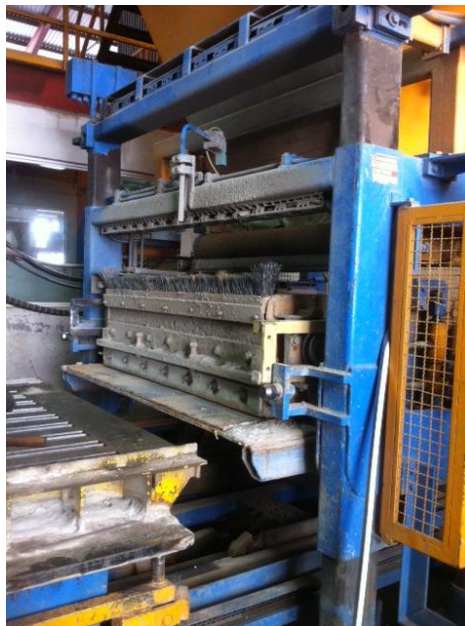
Imagen 38: Elaboración de block de molde
