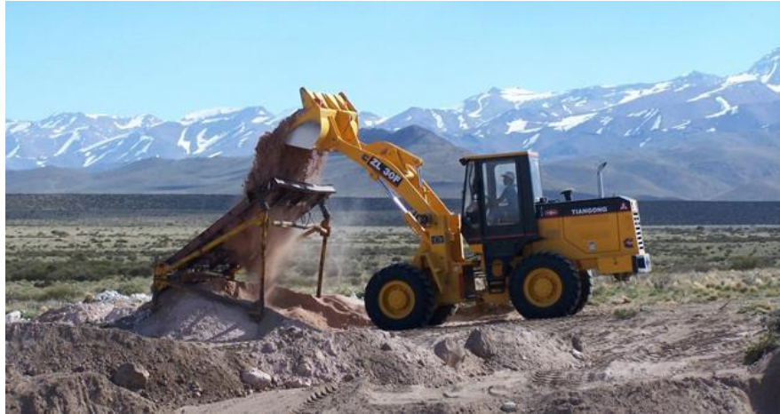
Imagen 27: Tamizado de piedra pómez para su extracción
