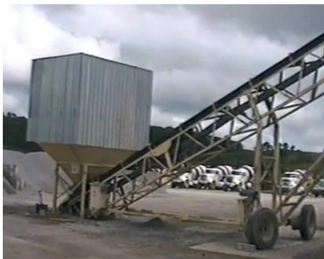
Imagen 78: Tolva donde ingresa la materia prima a utilizar para la producción del material que es llevada a los silos de almacenamiento.
