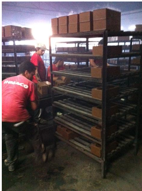
Imagen 52: Apilación de ladrillo para el proceso de secado
