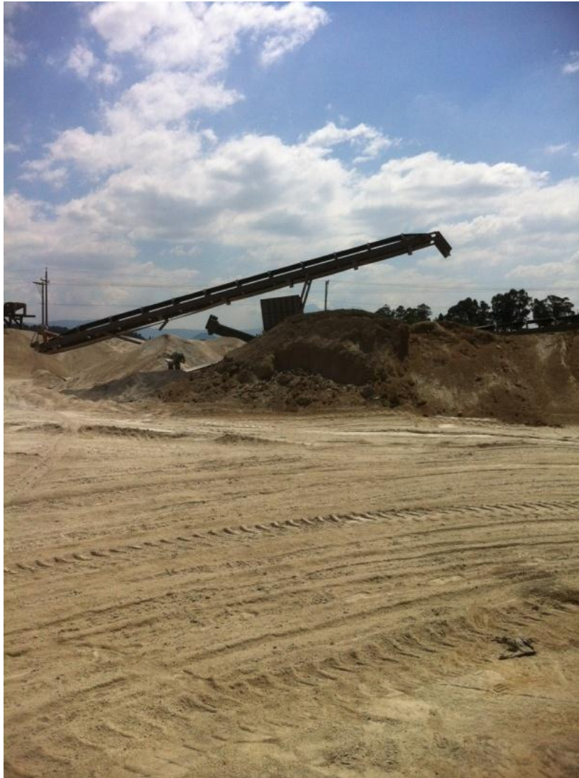
Imagen 32: Arena almacenada previo a ser llevada en bandas para el mezclado de materiales
