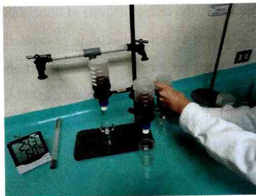
Ilustración No. 1 Método para determinación de mejor disolvente
