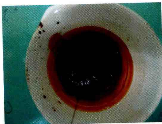
Ilustración No. 2 Crisoles utilizados para evaporación de disolvente
