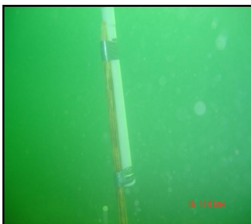
FIGURA 9. Trampa de sedimento colocada.
