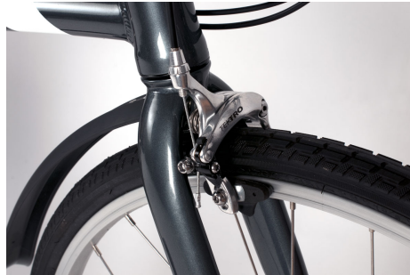
Figura 16: Mecanismo de frenado en bicicleta con cable Bowden [15]
