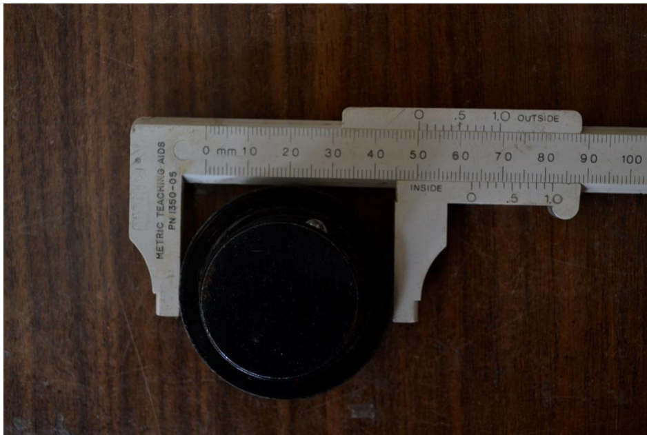
Imagen 18. Punta de acero del gato hidráulico utilizado para ensayar el modelo físico.
