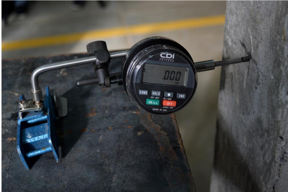
Imagen 19. Deformímetro digital utilizado para medir la deformación del modelo físico durante el ensayo.
