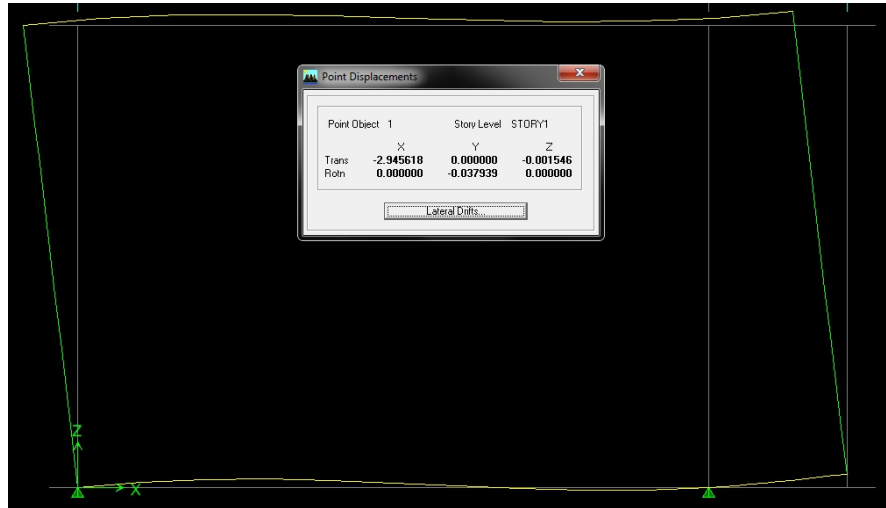
Figura 24. Valores de deformación del modelo computacional modificado en escala 1:4
