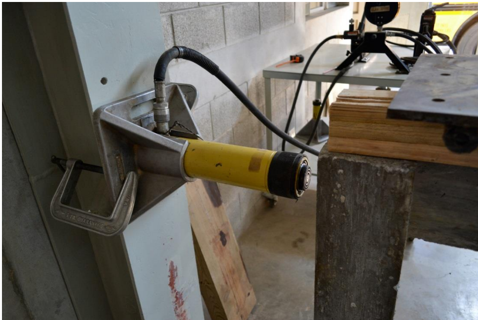
Imagen 20. Gato hidráulico utilizado para aplicar una carga lateral puntual al modelo físico.
