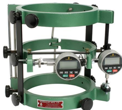
Figura 7. Compresómetro/extensómetro utilizado para determinar el módulo de elasticidad.
