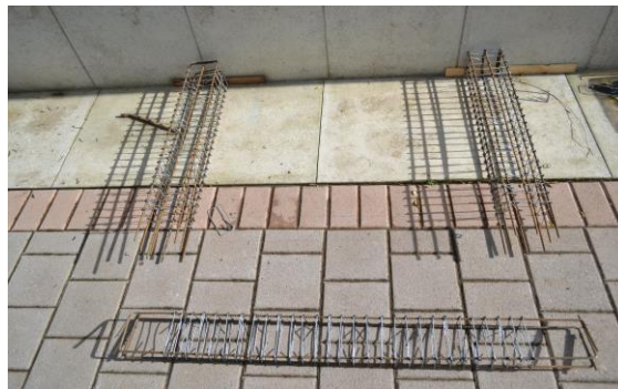
Imagen 10. Armadura del marco a escala.
