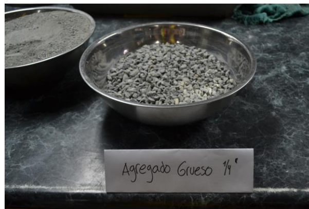
Imagen 2. Muestra de grava caliza utilizada como agregado grueso.
