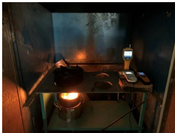
Figura 35: Medición de emisiones.
