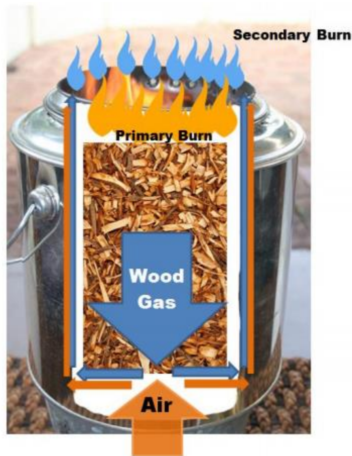
Figura 1: Principio de TLUD
