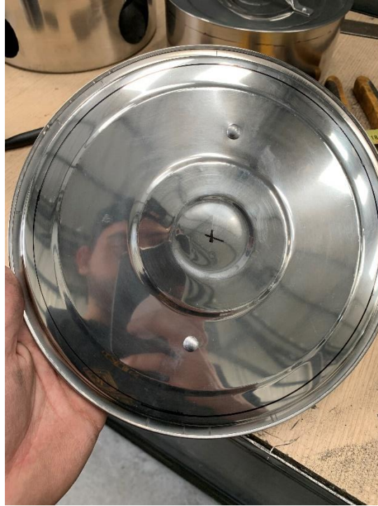
Figura 26: Marcado de diámetro en tapadera.
