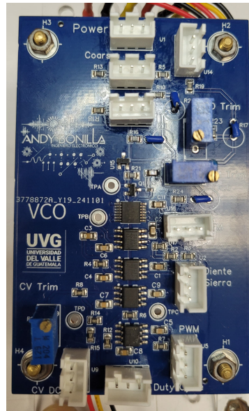
Figura 46: PCB físico ensamblado de VCO
