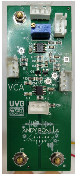
Figura 54: PCB físico ensamblado de VCA
