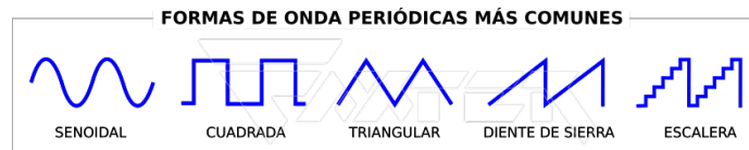
Figura 15: Tipos de onda producidas por oscilador 20
