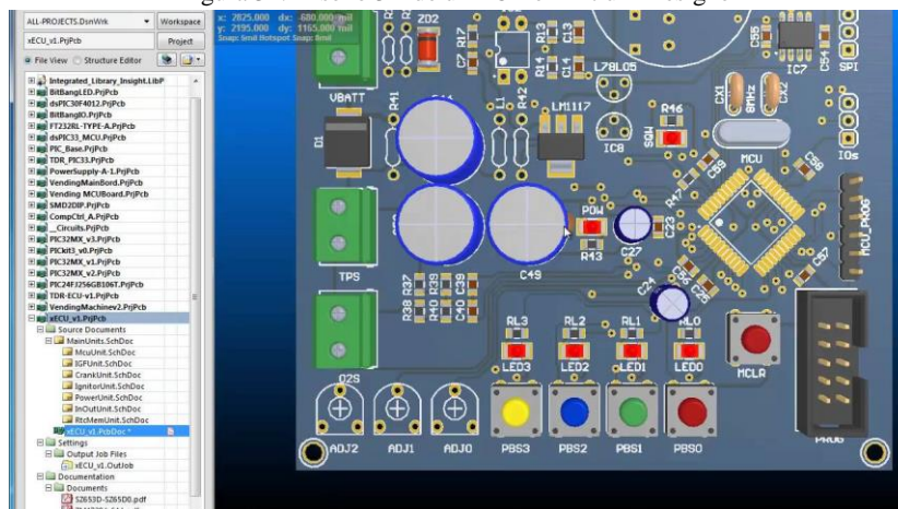
Figura 34. Diseño 3D de un PCB en Altium Designer
