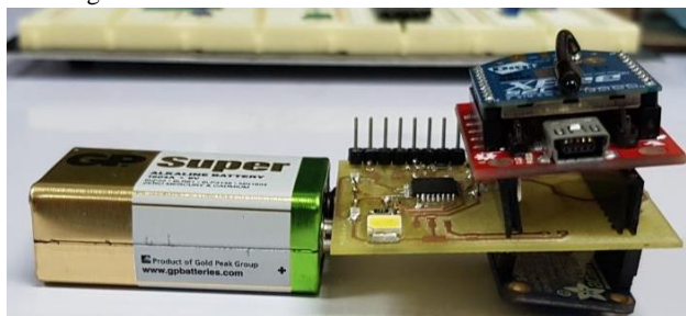
Figura 71. Sensor con headers hembra de ambos lados
