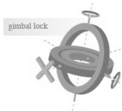
Figura 39. Bloqueo de ejes (Gimbal lock)
