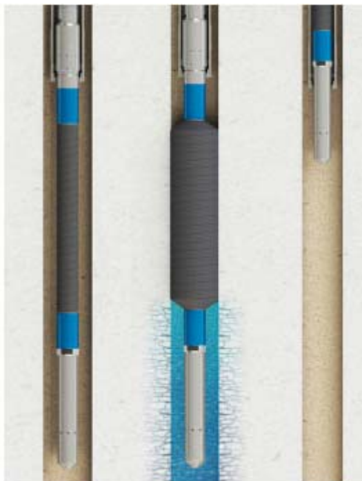
Ilustración 47: Esquema del funcionamiento de obturadores superiores
