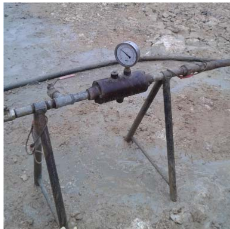
Ilustración 51: Caballete de presión equipado con manómetro.
