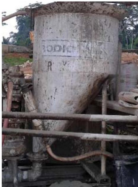
Ilustración 49: Mezclador de alta turbulencia
