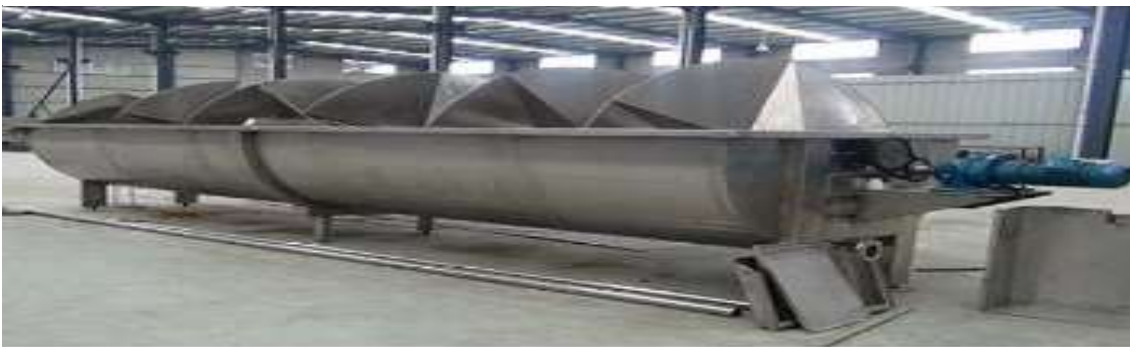
Ilustración 1: Pre chiller de enfriamiento
