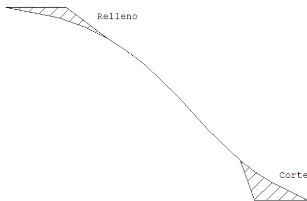
Fig III.3 (sección de talud; corte y relleno)
