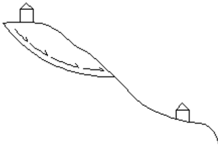
Fig. III.14 (sección con deslizamiento probable)
