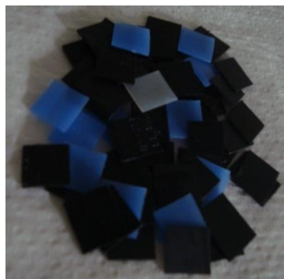
Figura 18. Partículas de 10 mm de HDPE (izquierda) y mezcla de LDPE y PP (derecha) obtenidas de las separaciones por densidad.
