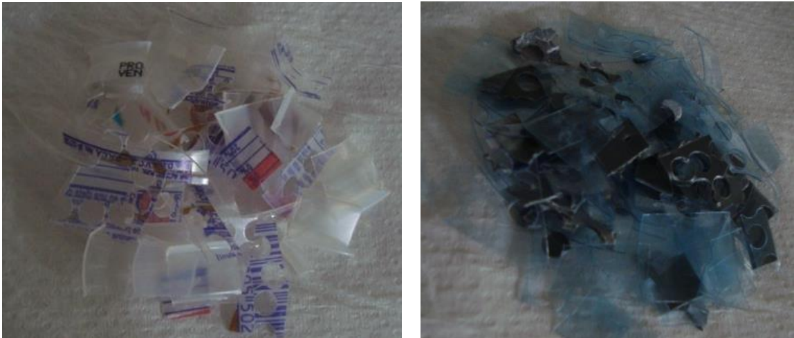
Figura 23. Partículas de tamaño variable de PS (izquierda) y mezcla de PET y PVC (derecha) obtenidas de las separaciones por densidad.
