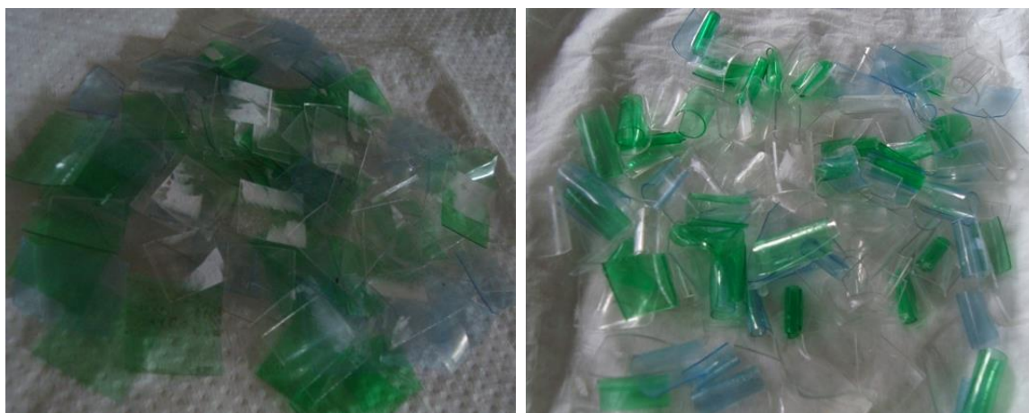
Figura 24. Plástico triturado antes (izquierda) y después (derecha) del proceso de lavado realizado a cabo a escala de laboratorio.
