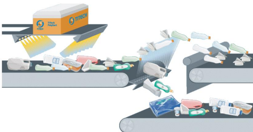
Figura 14. Tecnología de clasificación óptica.
