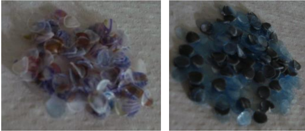
Figura 22. Partículas de 6 mm de PS (izquierda) y mezcla de PET y PVC (derecha) obtenidas de las separaciones por densidad.
