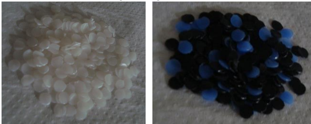
Figura 19. Partículas de 6 mm de HDPE (izquierda) y mezcla de LDPE y PP (derecha) obtenidas de las separaciones por densidad.
