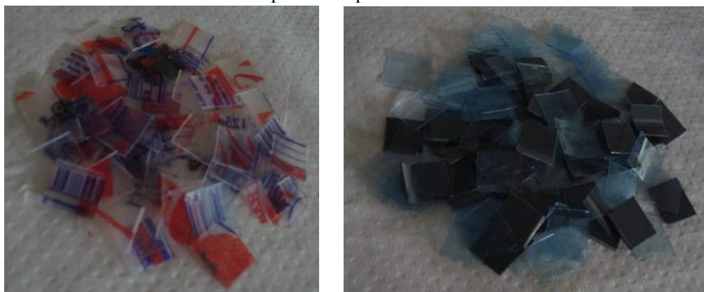
Figura 21. Partículas de 10 mm de PS (izquierda) y mezcla de PET y PVC (derecha) obtenidas de las separaciones por densidad.
