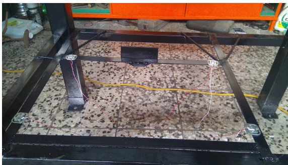
Figura 41: Sensores de peso colocados en la estrucutra
