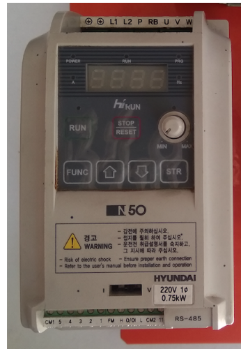
Figura 37: Variador de frecuencia utilizado
