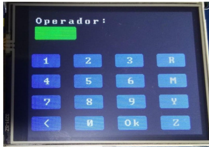
Figura 52: Pantalla de ingreso de operador
