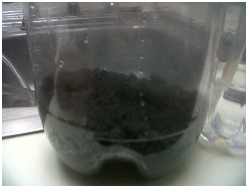
Ilustración 4 Depósito de tierra con hidrocarburo
