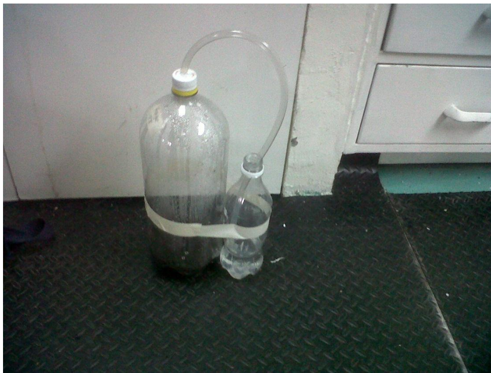
Ilustración 2 Sistema con el cual se midió la degradabilidad
