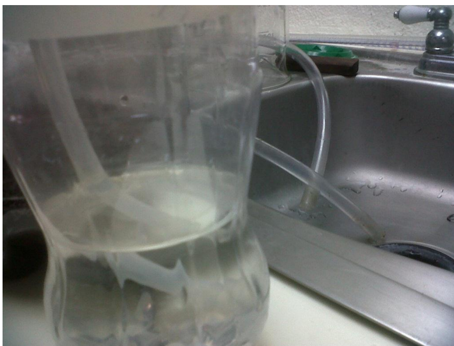
Ilustración 3 Absorción del CO 2 por el KOH
