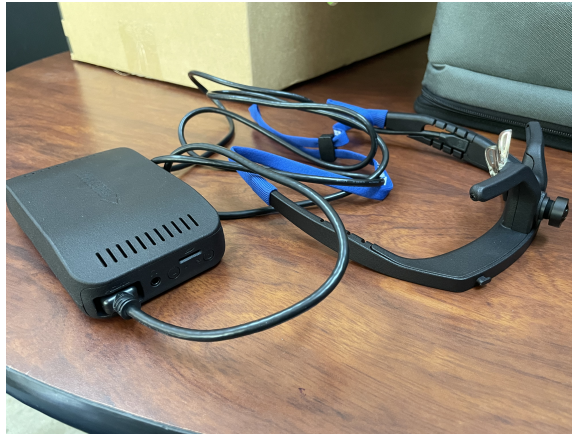
Figura 32: Conexión entre gafas con sensores y cámara, y el controlador
